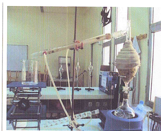
Figure III.13 : Montage de l'entraînement à la vapeur d'eau.
