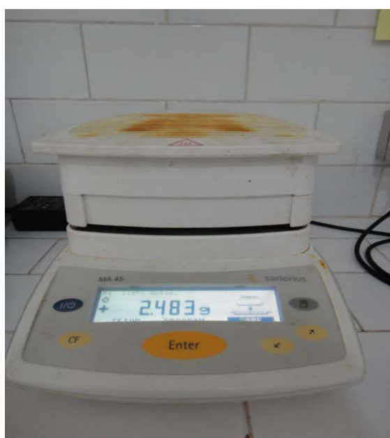
Figure 14: Le dessiccateur à infrarouge utilisée pour la détermination de la teneur en eau.
