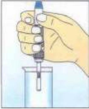
1)- Retirer le stylo de son capuchon et prolonger le stick échantillonneur dans un liquide à analyser. Les stries doivent entièrement dans ce liquide.
