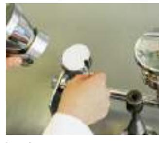
2-Déposer les membranes 1,2µm dans la rampe
