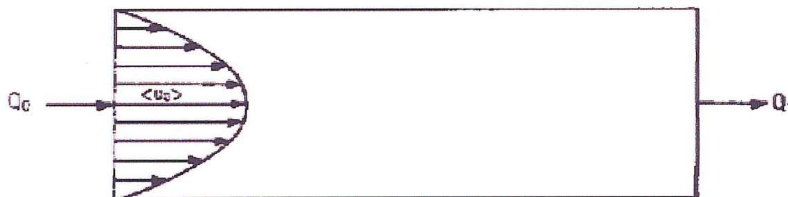
Figure 2.3 : Profil parabolique de la vitesse lors d'un écoulement de Poiseuille [96].
