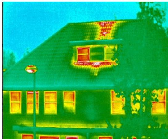
Figure 2-8: une perte de chaleur par le toit et aux niveaux des fenêtre
