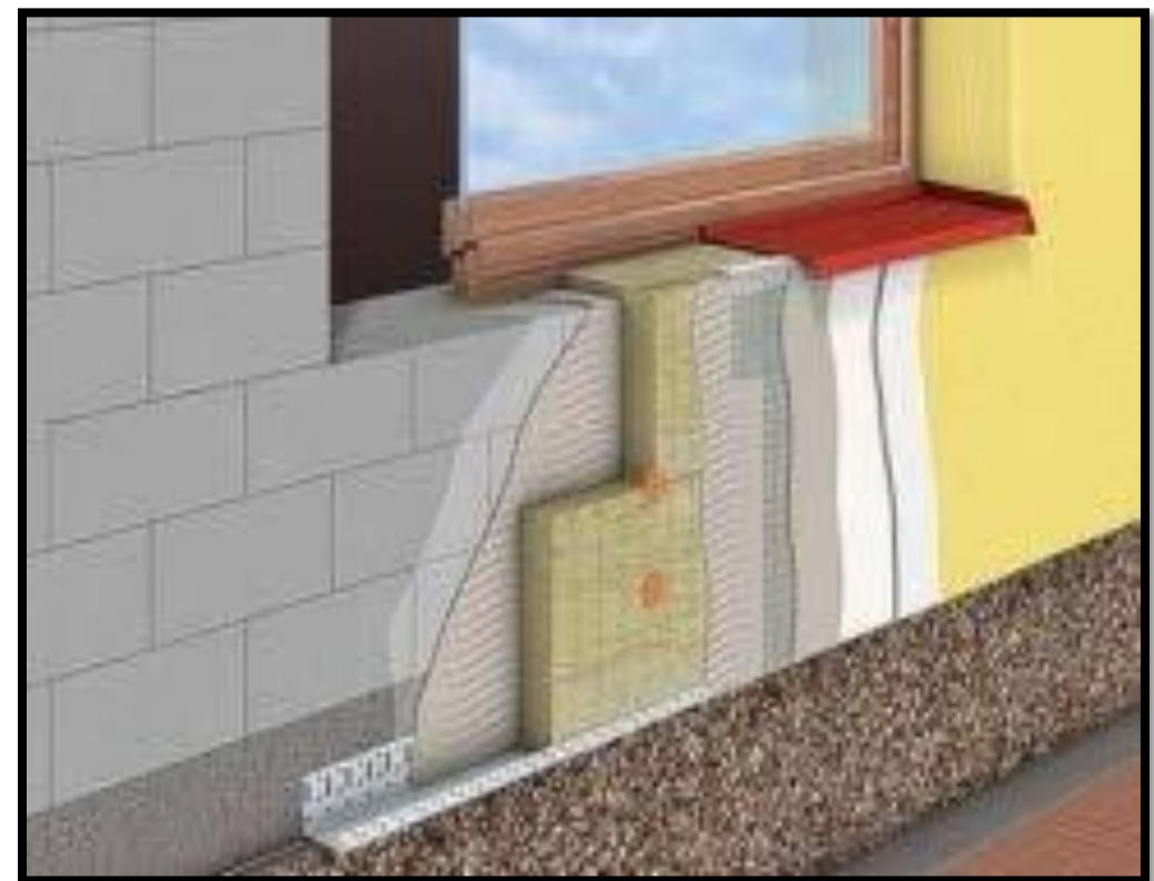
Figure : Isolation des murs par l'extérieure.
