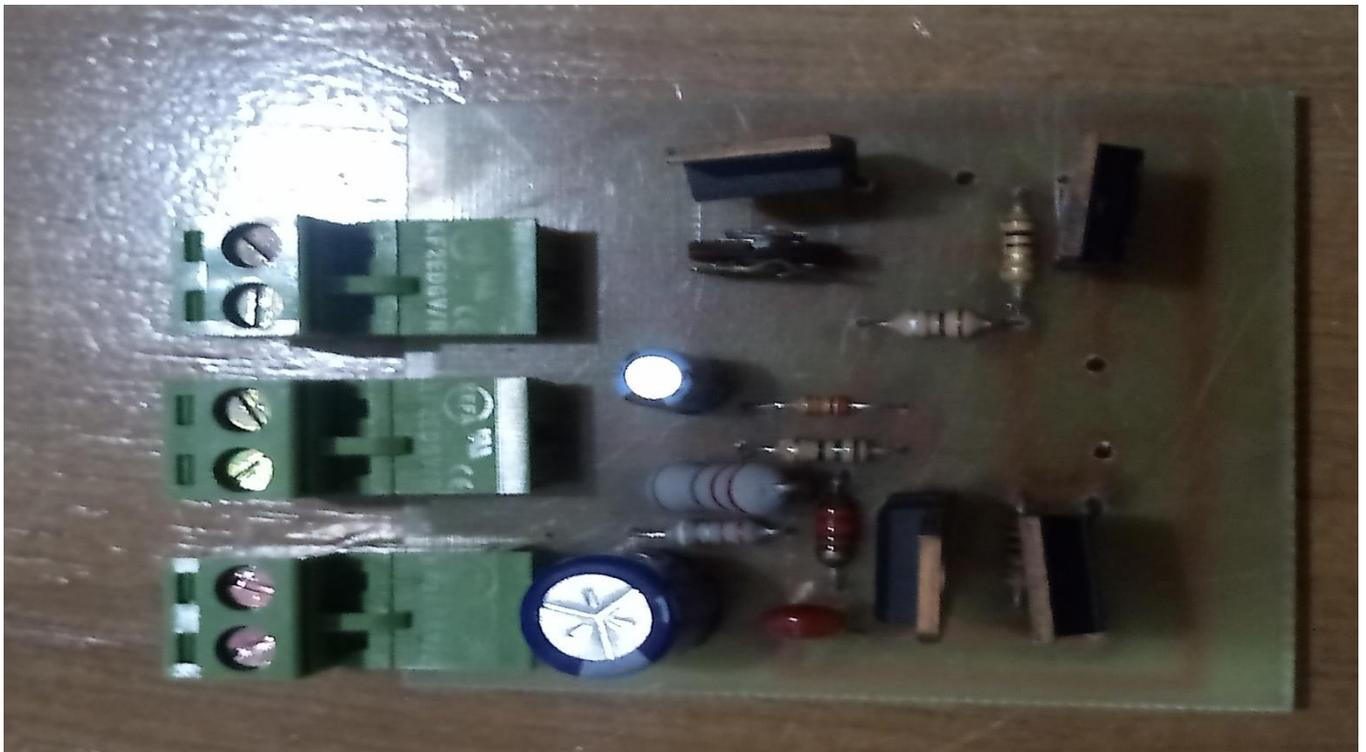
Figure 3.16 : Carte électroniques de notre convertisseur boost avec CALC
