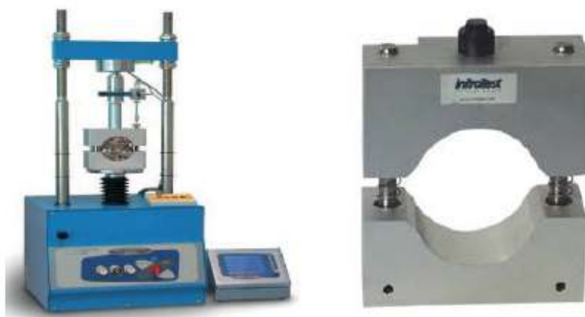
Figure 29. Machine d'essai Marshall [9]
