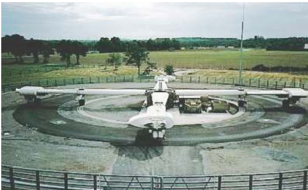
Figure 17. Manège de fatigue du Laboratoire Central des Ponts et Chaussées à Nantes.
