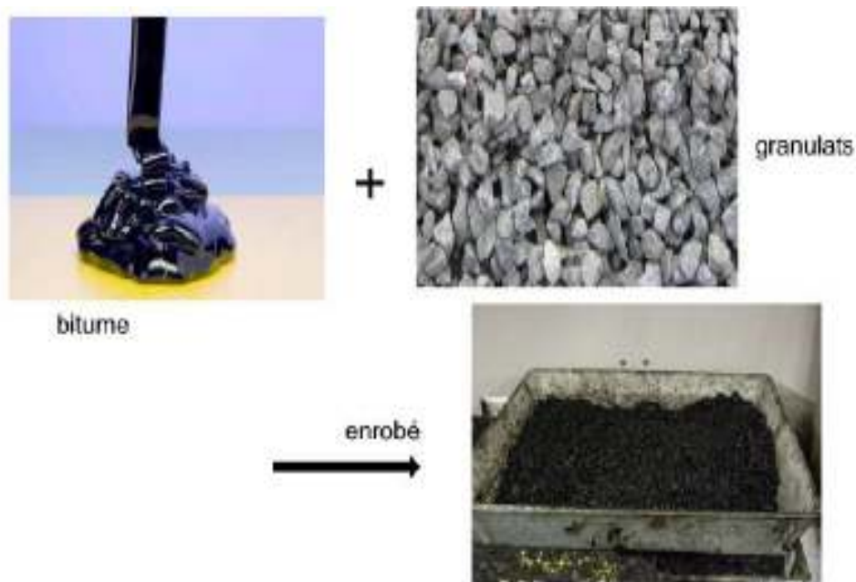
Figure 22. Composition de béton bitumineux [1]
