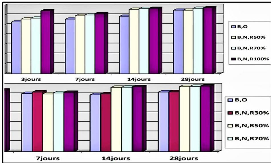
Figure I.21 : Résistance à la compression des éprouvettes conservées dans le traitement thermique à 300°C et 600°C [58]
