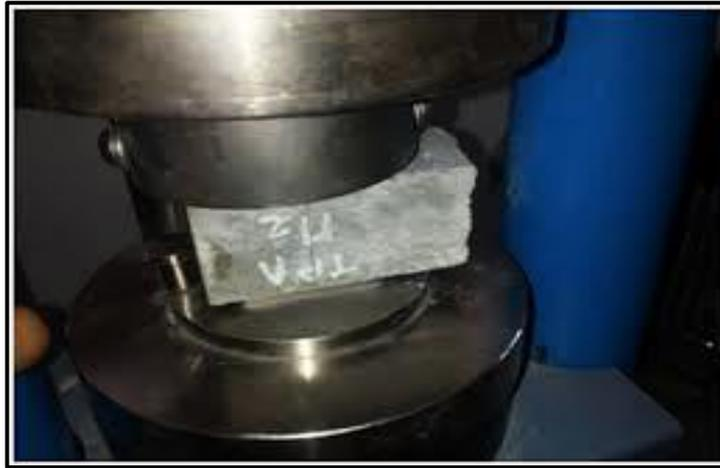
**Figure II.15:** L'essai de résistance à la compression.
