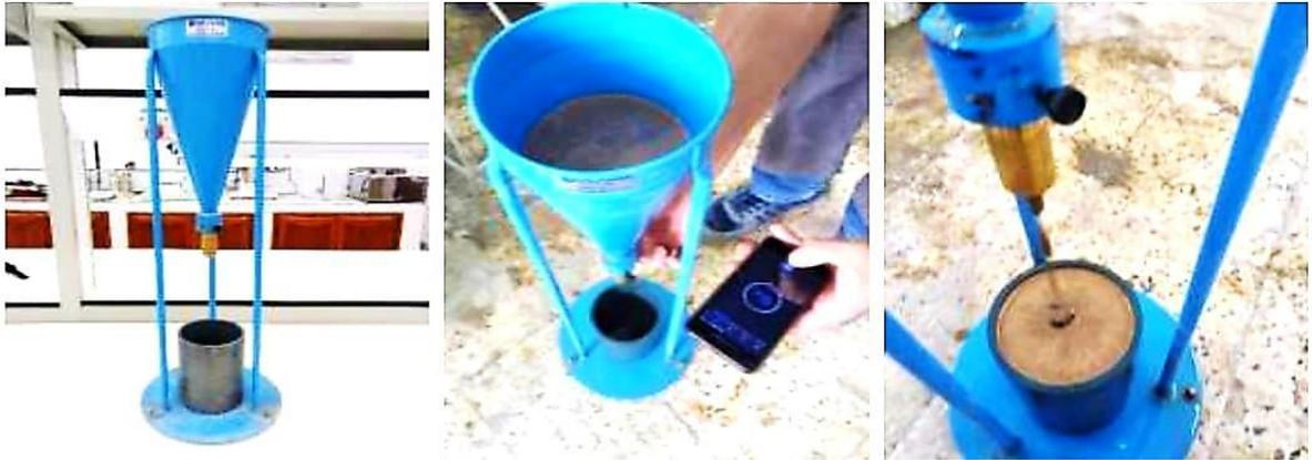
**Figure II.11:** Essai au cône de Marsh.
