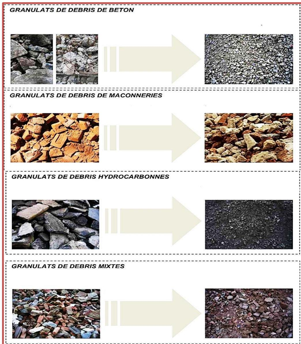
Figure I.8 : Différentes origines de granulats recyclés[4]
