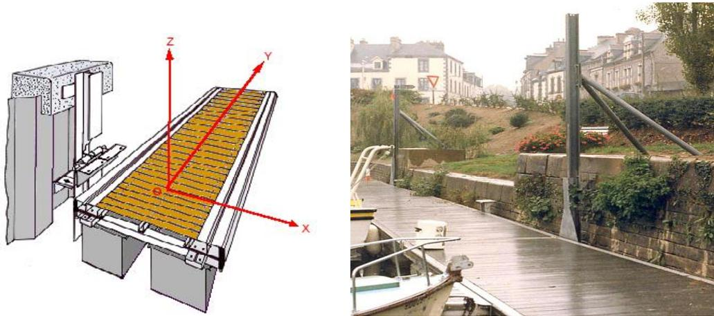
Figures 3.64 et 3.65 Schéma de guidage sur Rail d'un appontement
