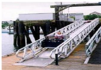
Figure 3.45 Passerelle et ascenseur, appelé "Ramp Rider".
