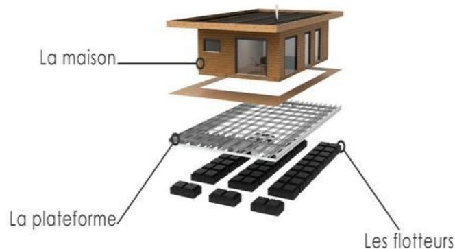
Figure 3.15 : les différentes parties de la structure flottante
