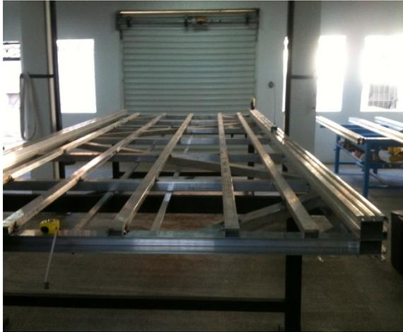
**Structure principale en alliage d'aluminium**
