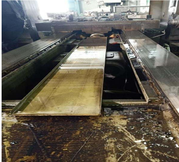
Figure V.1 : cache de protection de la boite
