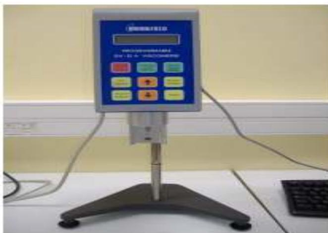
**Figure 16:** Photographie de Viscosimètre Brookfield
