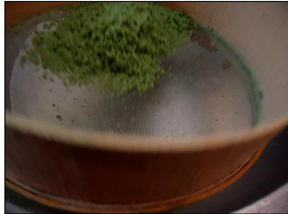
Photo 10 : calibrage du mélange humide
