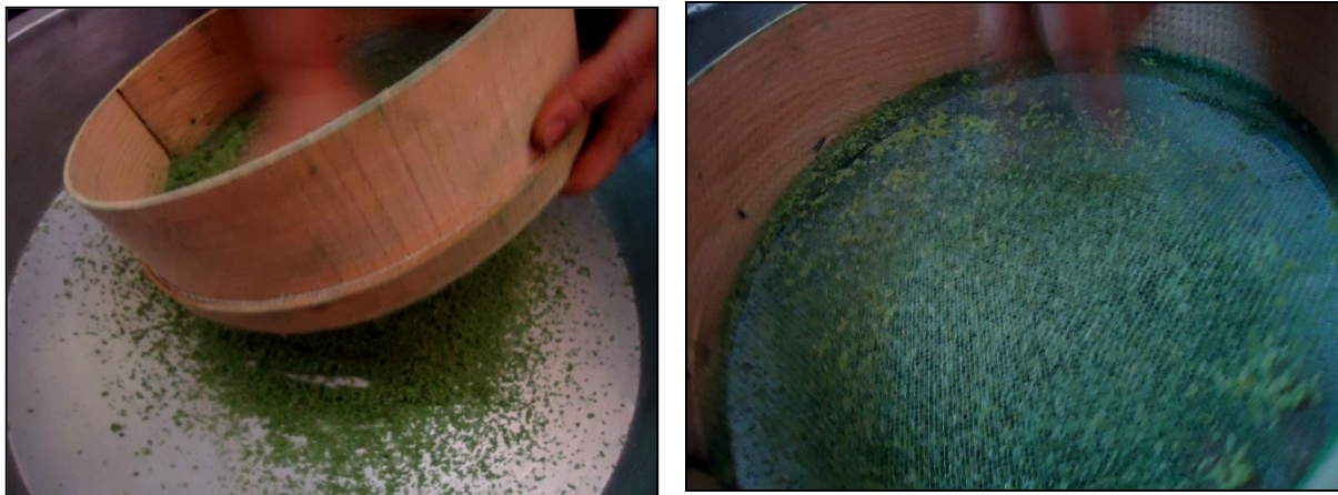
Photo 13 et 14 : Tamisage et calibrage de couscous tamis kherredj (2000 \mu\text{m} )
