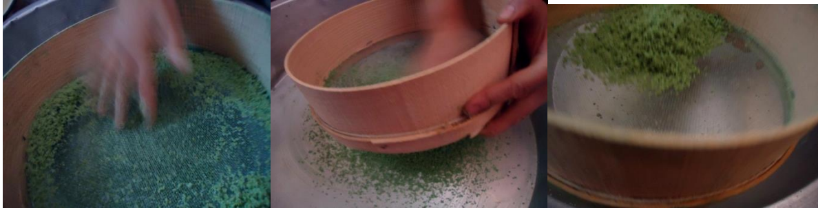
Figure : Etape de grenaison (calibrage (T Ke 2200 \mu m))(photo originale)
