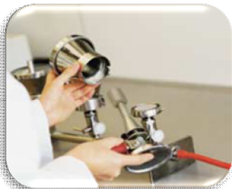
1-Stériliser la rampe
