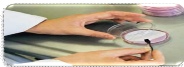
4-Déposer les membranes sur les boîtes de Petri contenant les milieux spécifiques aux germes recherchés
