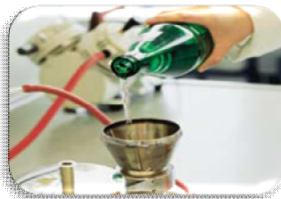
3-Filtrer X ml des échantillons à analyser à l'aide de spatule de prélèvement et actionner la pompe à vide
