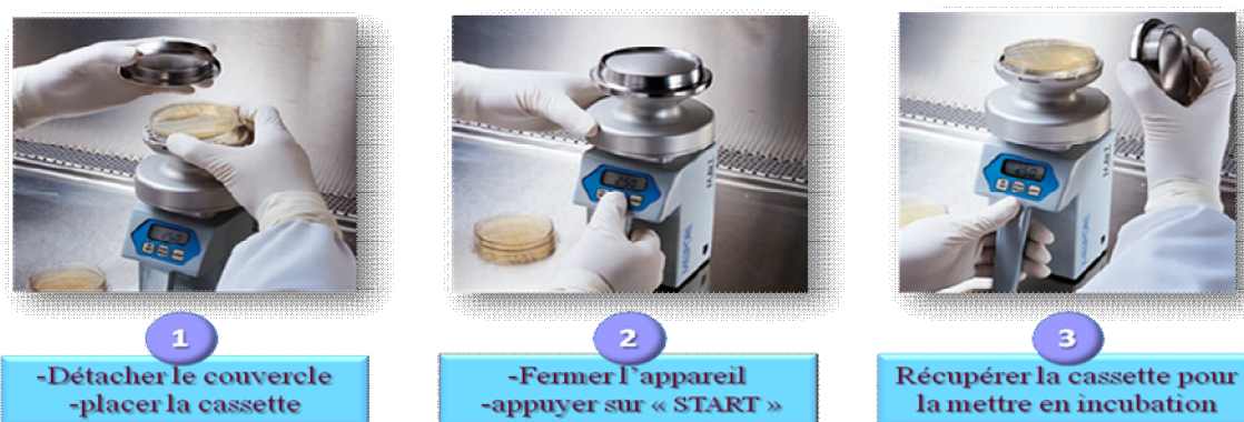
Figure 13: Les étapes du contrôle microbiologique de l'air par aspiration.
