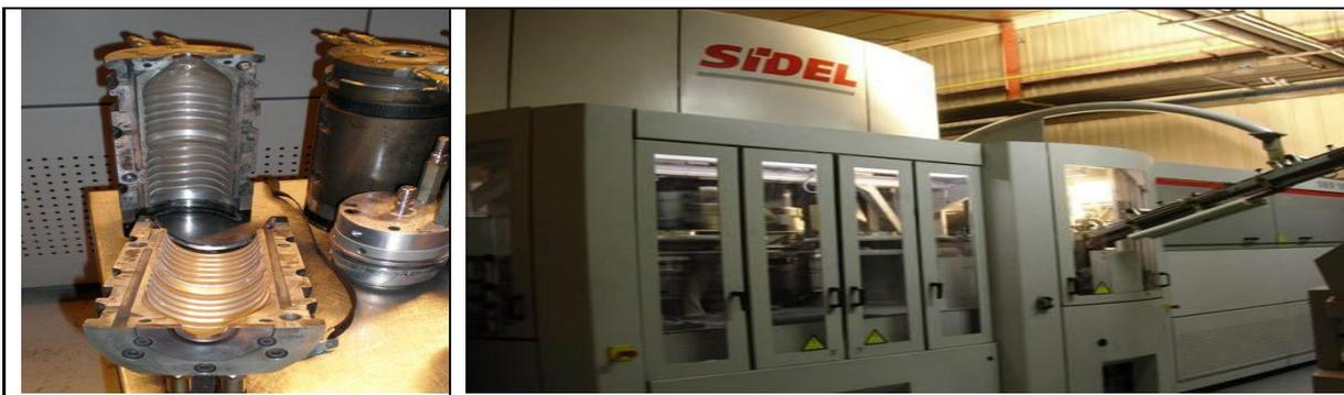
**Fig.06. Moule ouvert dans lequel les bouteilles sont chauffées (Anonyme, 2008)**
