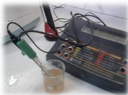
**Figure V.3** : photographie d'un PH-mètre de type HANNA.
