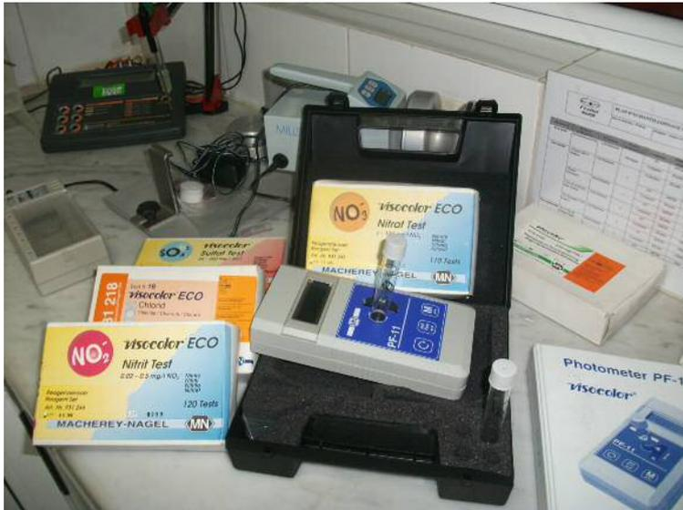
Photomètre PF11 et les réactifs
