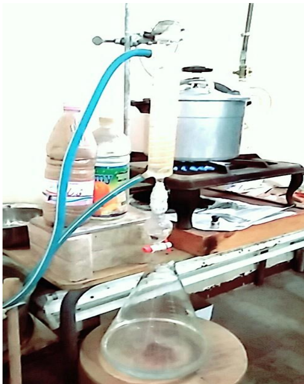
Figure 18 : Matériel d'hydro-distillation employé pour l'extraction de l'huile essentielle de menthe poivrée
