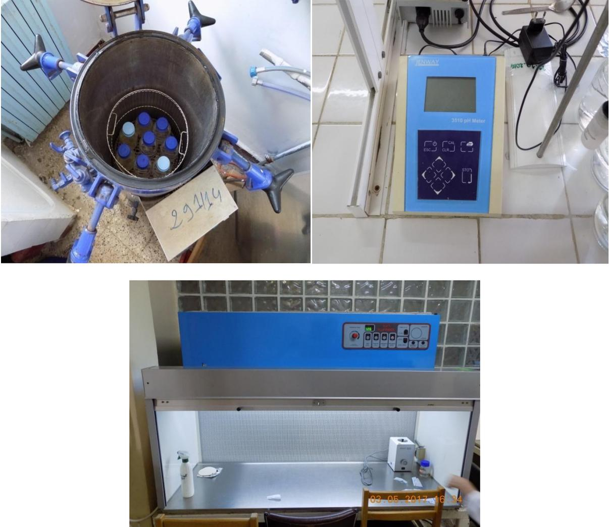
**Figure50** : Autoclave, pH mètre et Hotte à flux laminaire horizontal.
