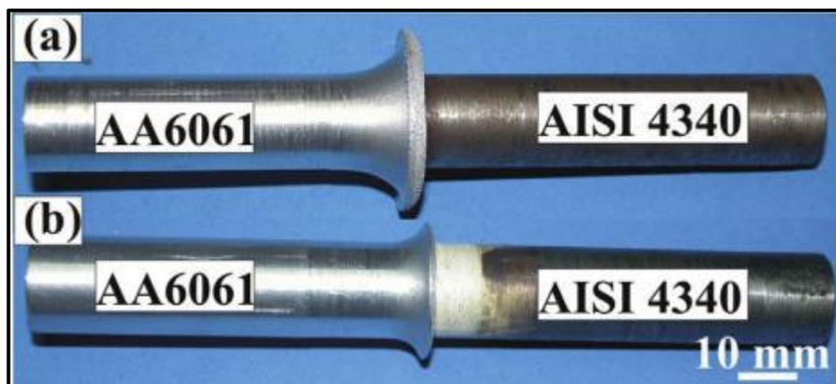
Figure 1.17 : Macrographie de soudage par friction AA6061-AISI 4340 [47].
