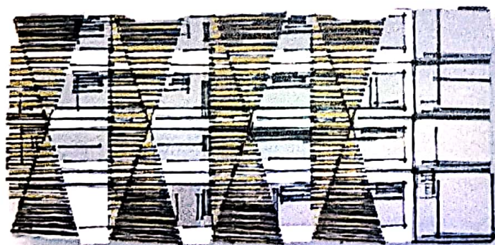
Figure 81 : esquisse de proposition de brise solaire sur la façade sud Source : auteur
