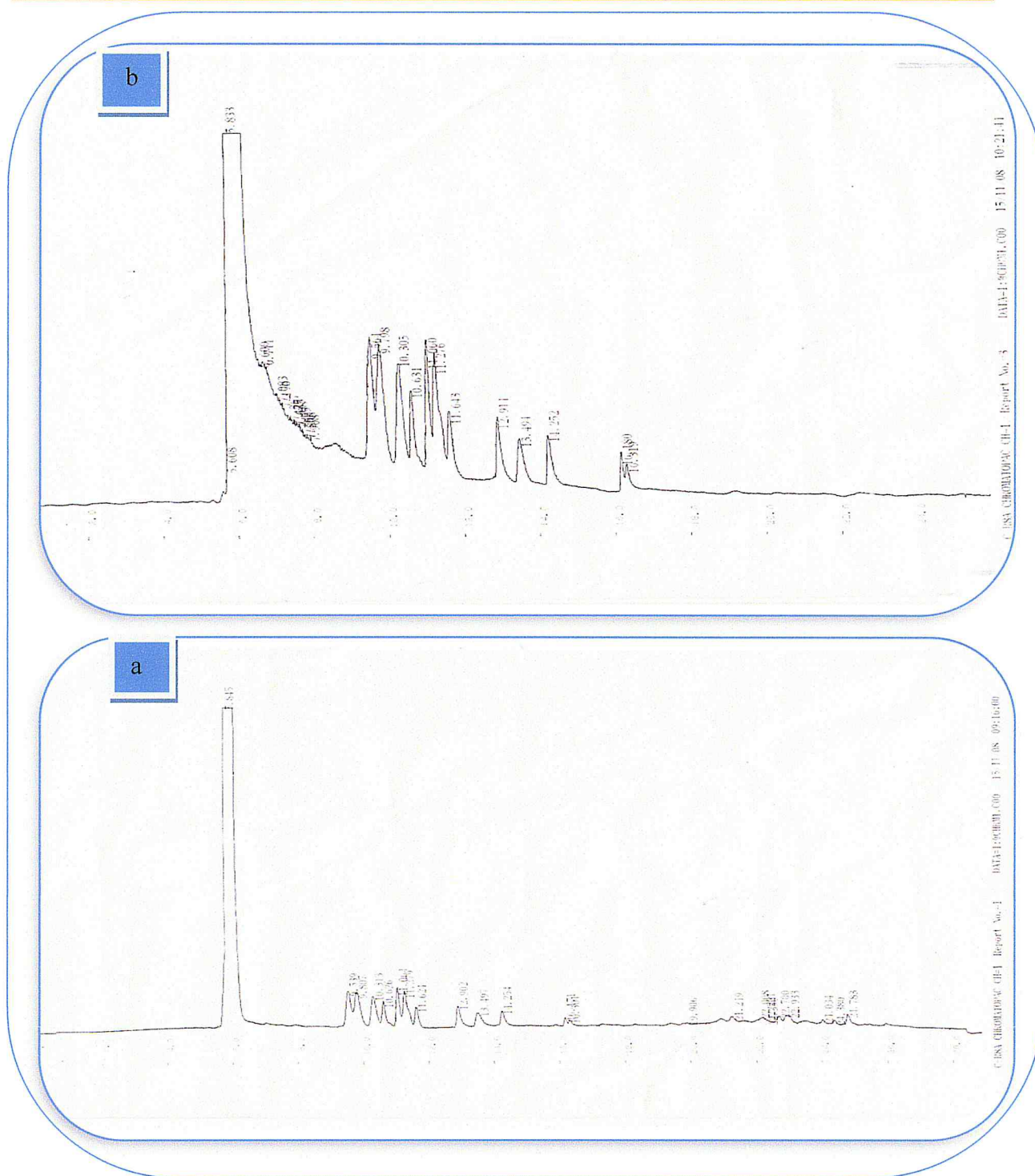
Figure IV-15: Chromatogramme de notre huile brute en (a) et l'huile traitée avec le SDS en (b) réalisé sur un appareil Hewlett Packard Agilent6890N.
