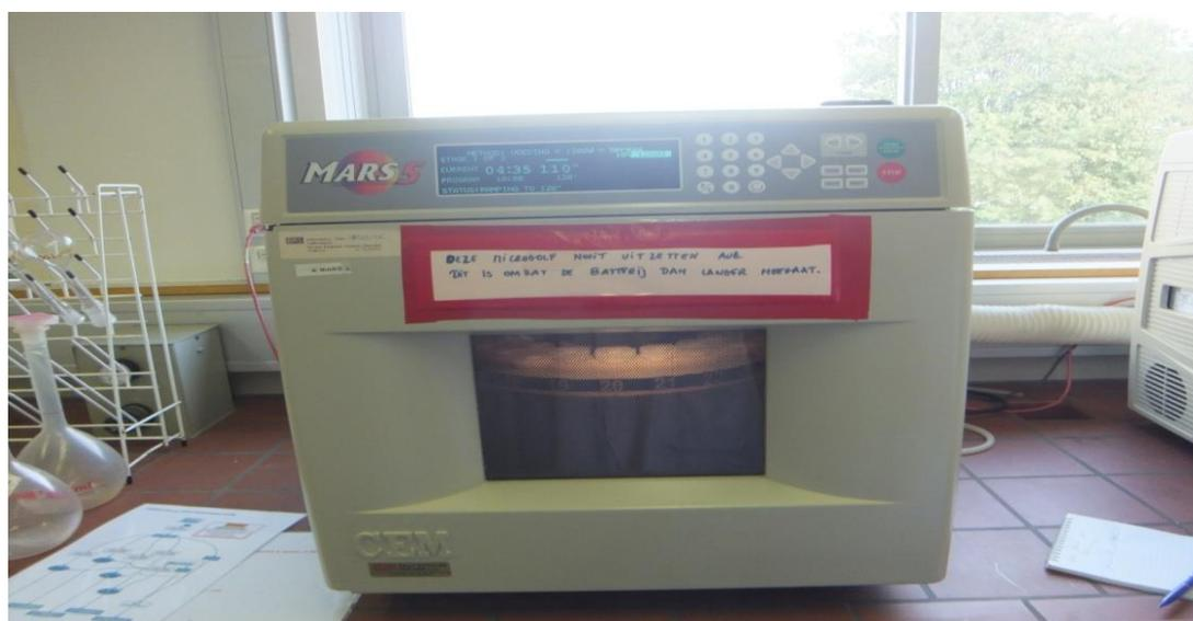
**Figure 5.10** : Digestion sous pression par microonde (MARS EXPES).
