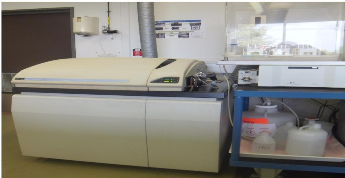
**Figure 5.2 :** Spectromètre de Masse par Plasma à Couplage Inductif (Perkin Elmer sciex).
