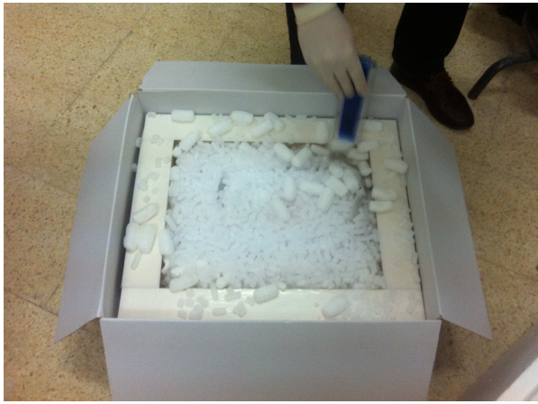
Figure 8.5 : caisse UN3373 dotée de gaz carbonique
