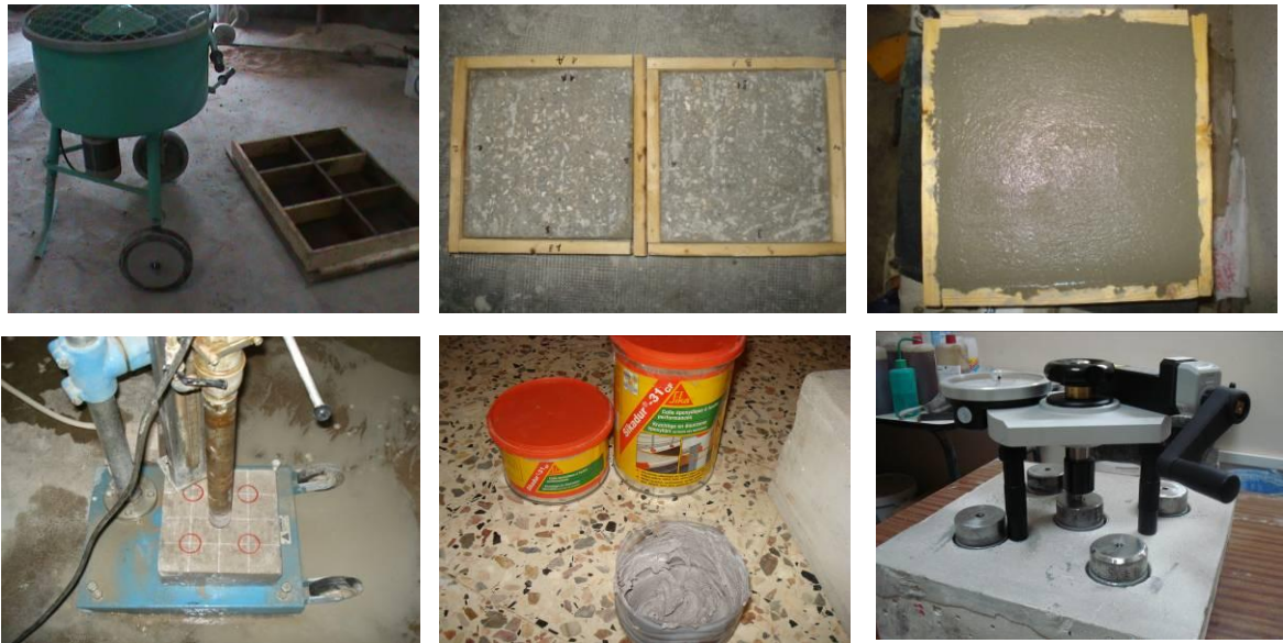
Figure 2.19 : Préparation des échantillons pour l'essai d'arrachement (Pull-off).
