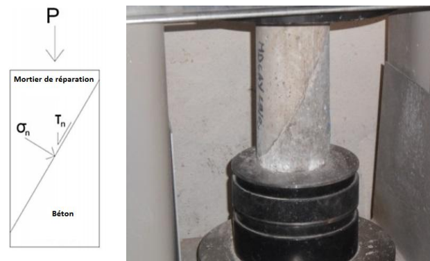
Figure 2.17: Forme de composite béton-mortier de l'essai de cisaillement oblique.
