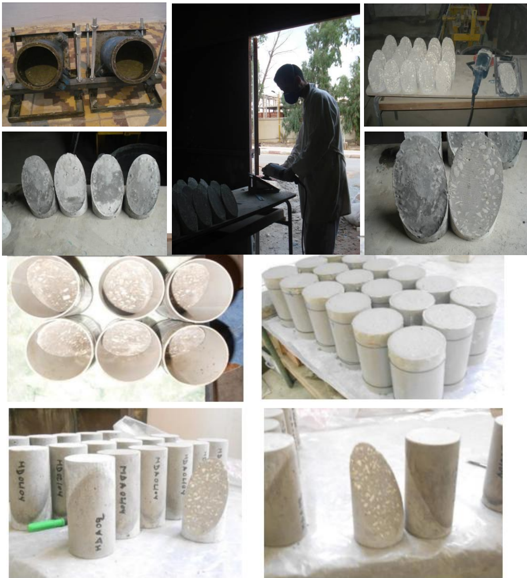
Figure 2.18 : Préparation des échantillons pour l'essai de cisaillement oblique (Slant-shear).
