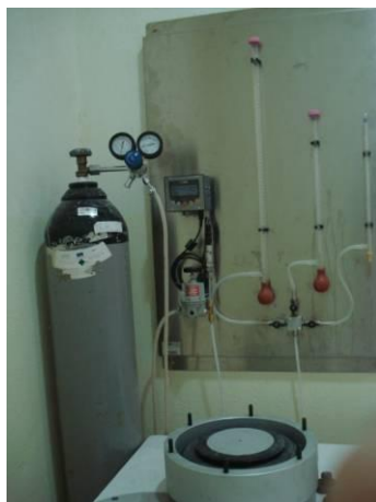
Figure 2.16 : Montage de l'essai de la perméabilité au gaz.
