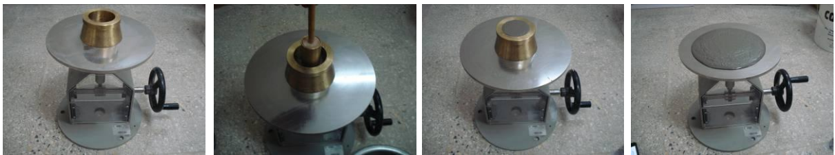
Figure 2.8 : Essai d'étalement de table à secousse.
