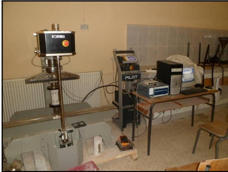
Figure 2.13: Dispositif de mesure du module d'élasticité.
