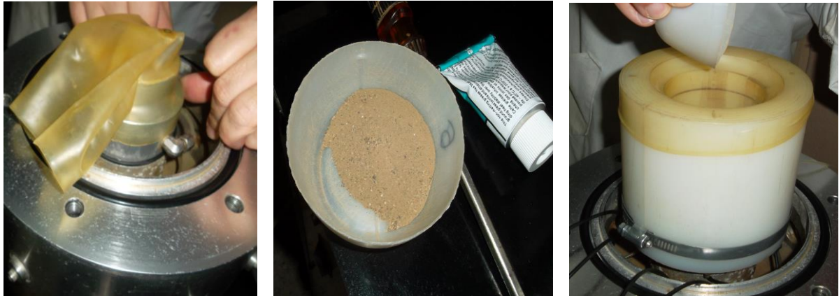
Figure 2.10: Préparation d'un échantillon pour l'essai triaxial
