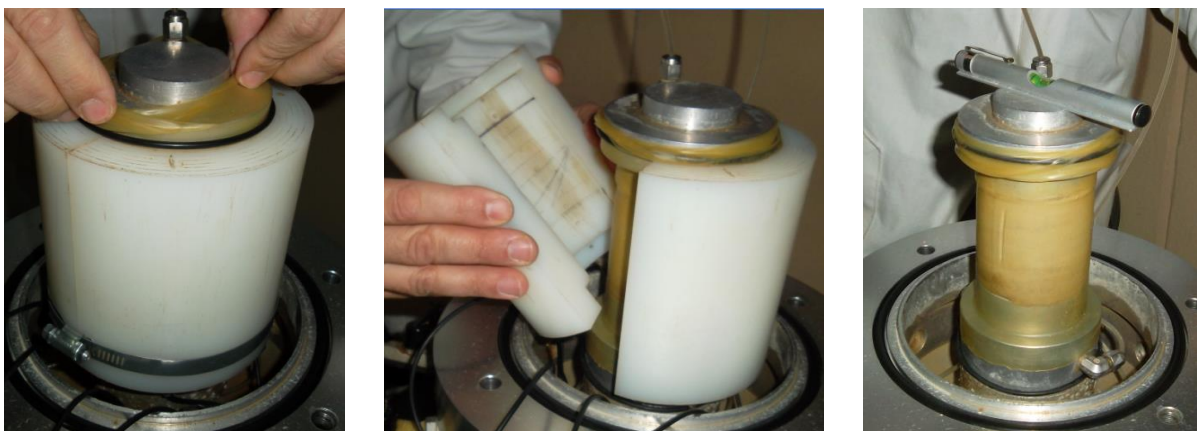
Figure 2.11: mise en place des échantillons dans la membrane d'un essai triaxial
