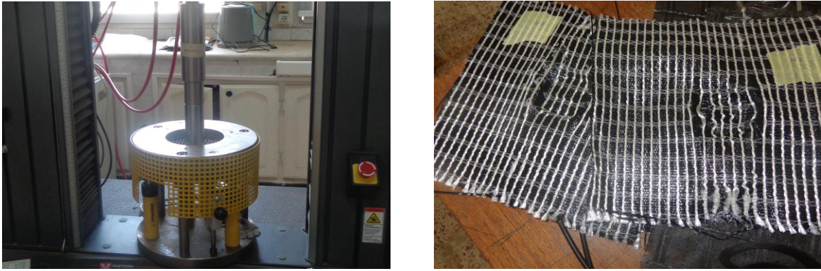
Figure A1.6: Résultats des essais de poinçonnement statique sur le géotextile. (a) Dispositif d'essai de poinçonnement ; (b) Résultats du géotextile
