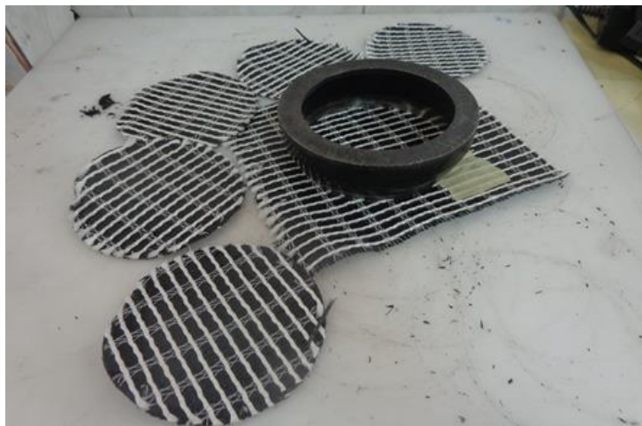
Figure A1.2 : Principe de calcul de la masse surfacique des géotextiles
