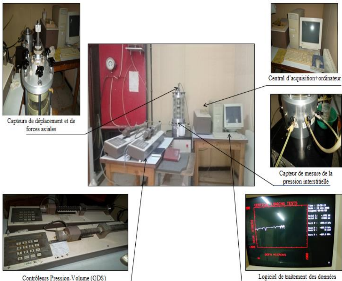
Figure 2.5: Vue de l'ensemble du dispositif de l'essai triaxial (Laboratoire des sciences des matériaux et de l'environnement, Université de Chlef)
