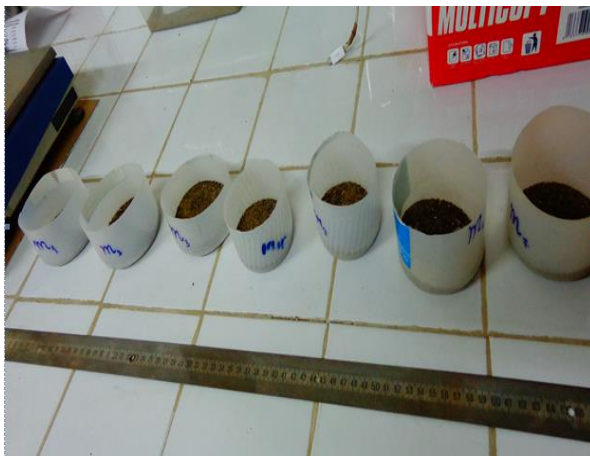
Figure 2.9: Préparation de l'échantillon par sous compaction
