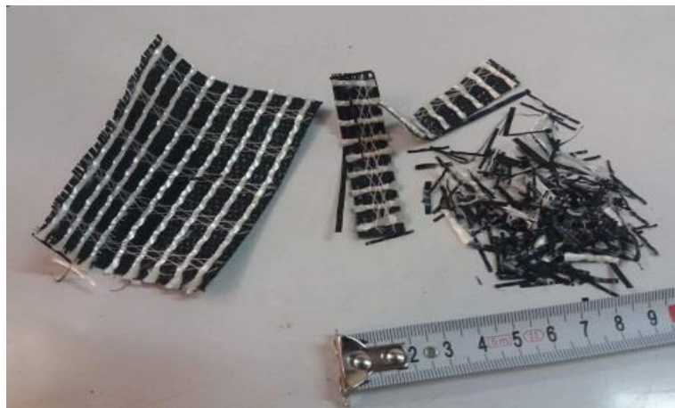
Figure 2.19: Géotextile utilisé dans cette étude: GEOTER 150
