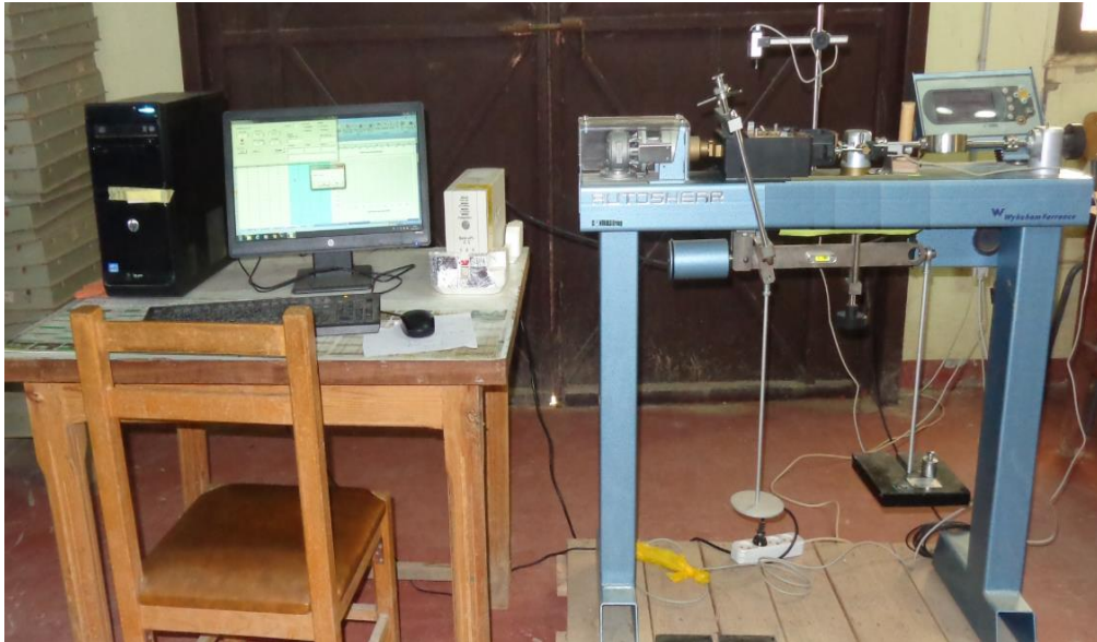
Figure 2.1 : Appareillage de cisaillement direct à la boîte
