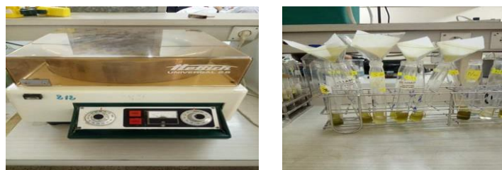
Fig. 18 : Centrifugation et filtration des échantillons (Original,2019)
