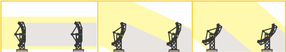
**Figure 2.7 :** Pertes d'ombrage entre deux rangées de CCP, [179]
