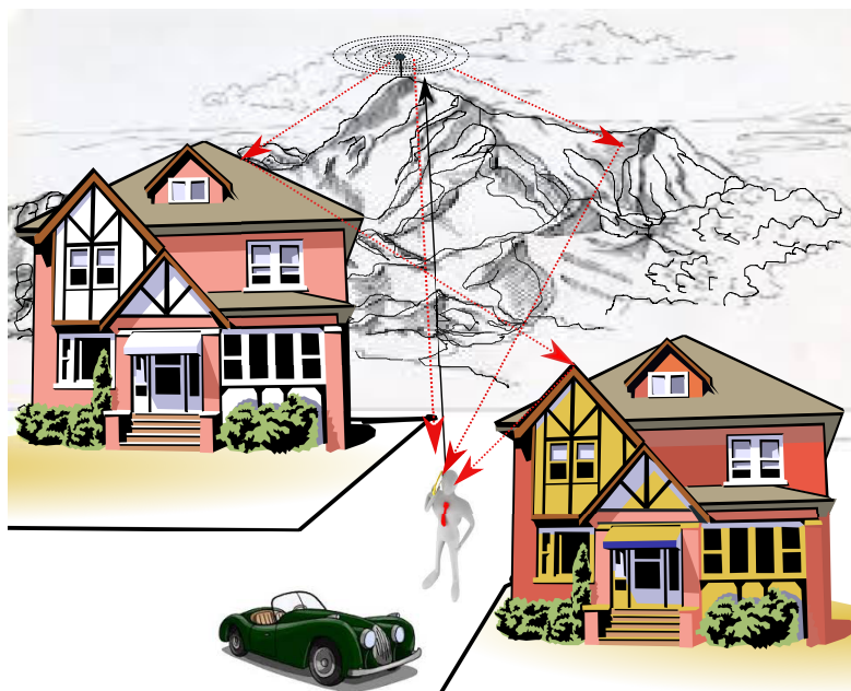
Figure 4.1 – Le problème du multi-trajets dans une communication sans fil.
