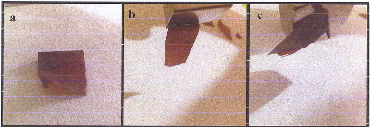
Figure III. 7: Images témoins montrant la réponse d'un fragment du film biocomposite préparé « *in-situ* » à un faible champ magnétique ; (a) le fragment est à l'état de repos, (b) et (c) le fragment est sous l'influence d'un aimant au néodyme
