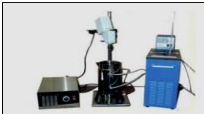
Figure 1.6 : Extracteur à ultrasons utilisé pour l'extraction d'une huile essentielle [25].
