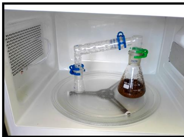
Figure 4.1 : Dispositif expérimental d'extraction assistée par micro-ondes.
