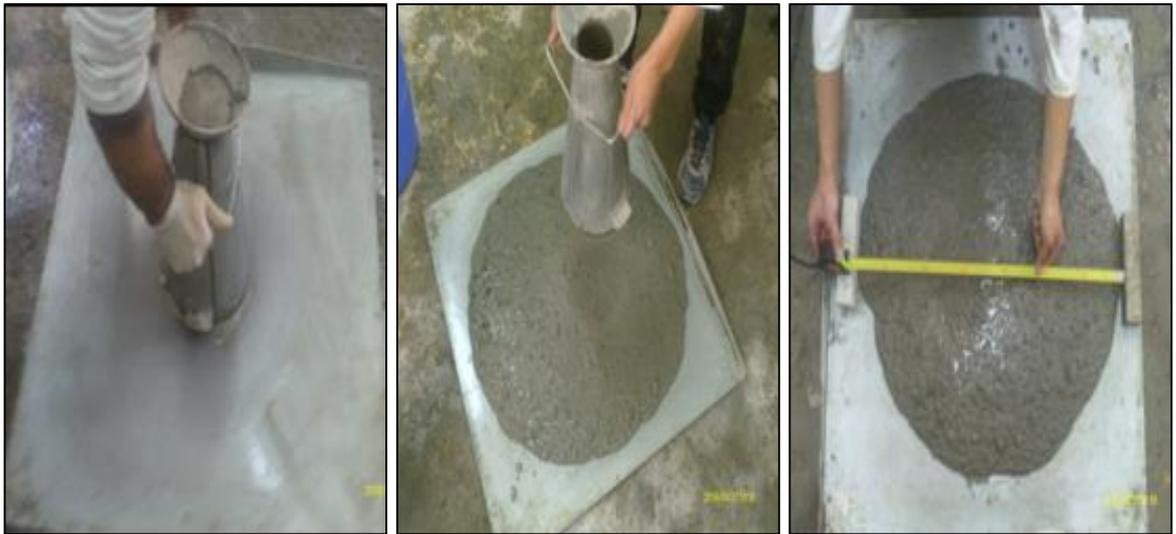
Figure 3. 11: Essai d'étalement.
