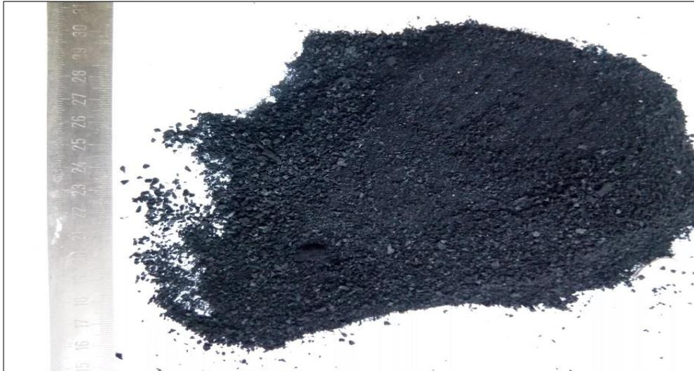
Figure 3. 3: Particules en caoutchouc utilisées dans le programme expérimental.
