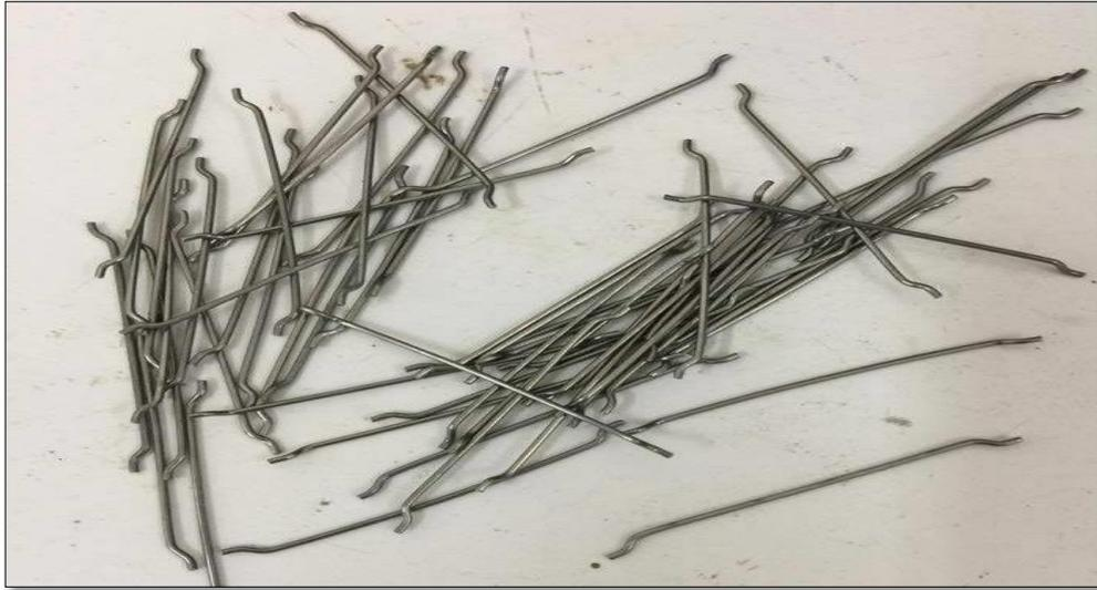
Figure 3. 7: Les fibres métalliques à crochets Dramix.
