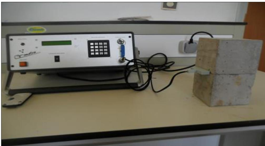
Figure 3. 19: Essai de la mesure de conductivité thermique.
