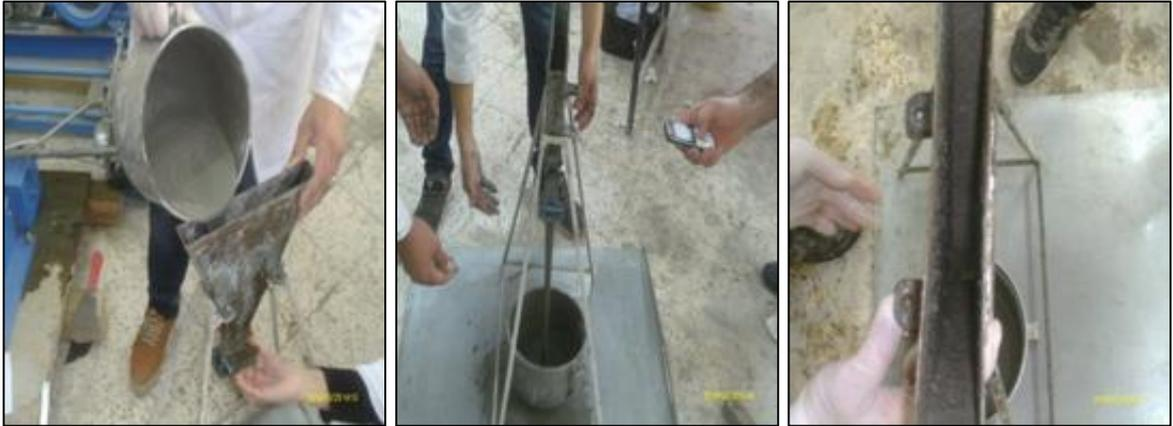
Figure 3. 10: Essai à l'Entonnoir en V pour Mortier
