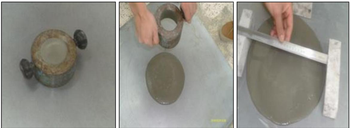
Figure 3. 9: Essai d'étalement pour Mortier.
