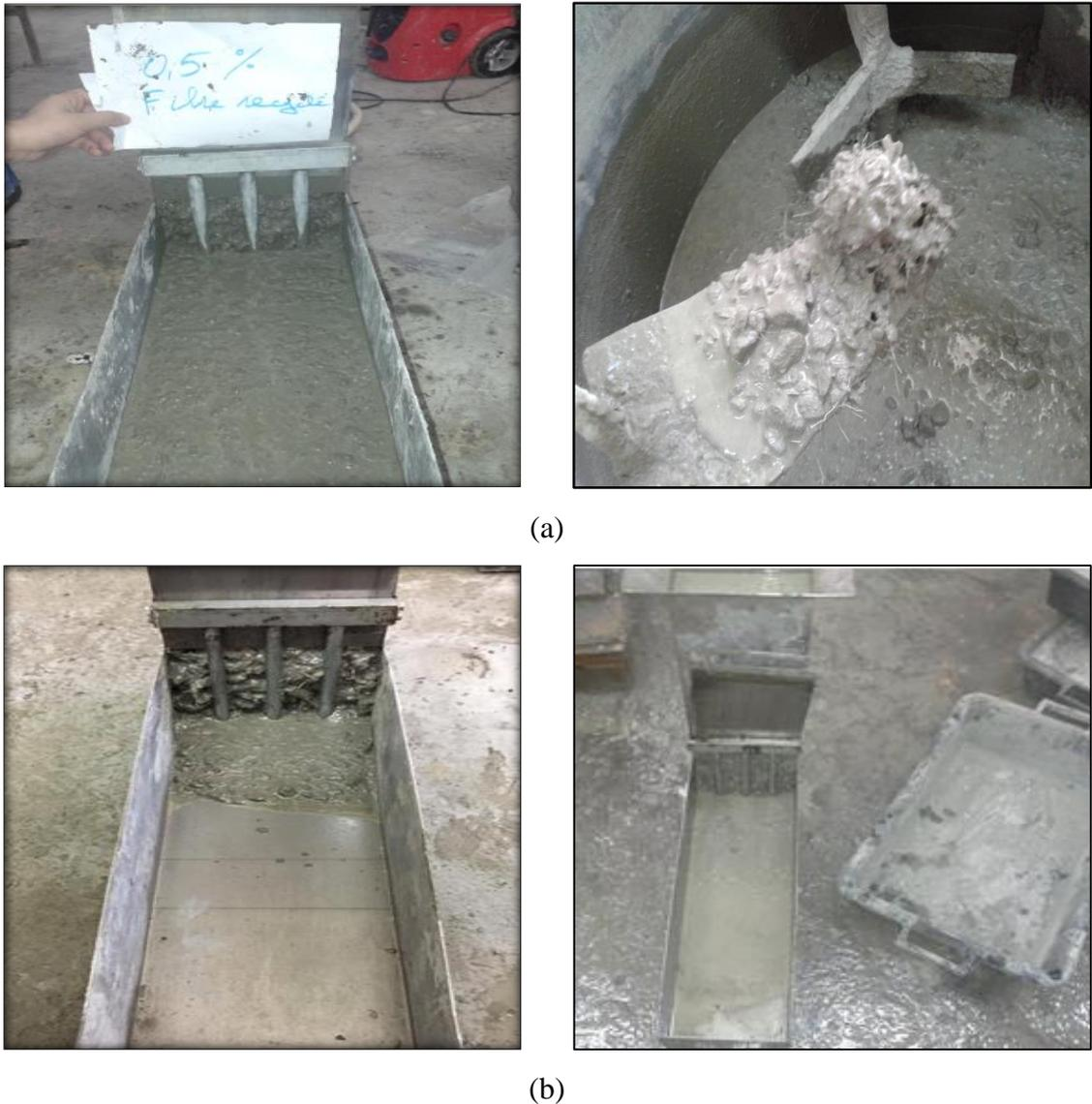
Figure 5. 7: illustration du blocage pour les BAP avec ; (a) FMR, (b) FM.
