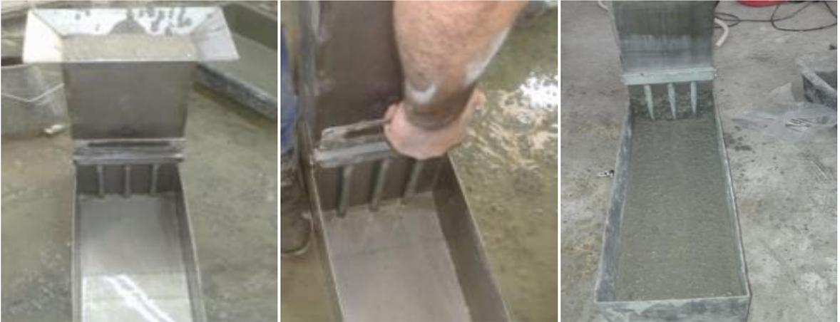
Figure 3. 13: Essai de la boîte en L.
