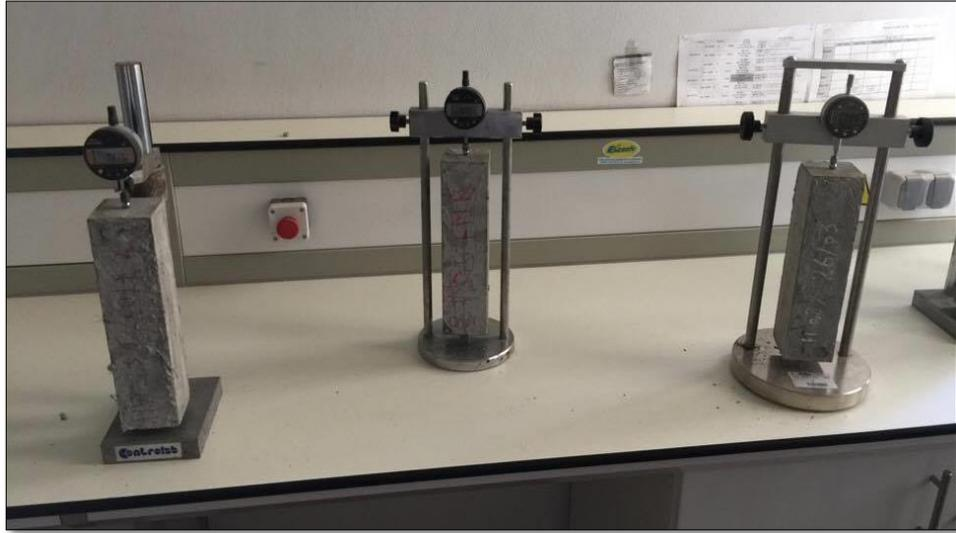
Figure 3. 18:Essai de retrait.
