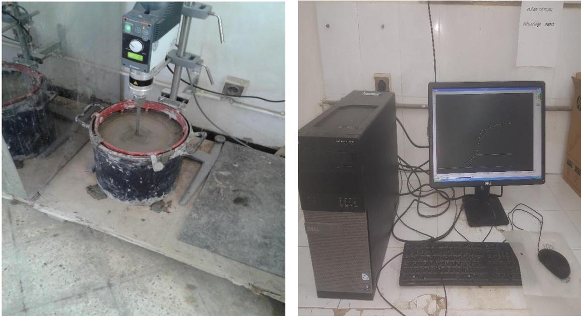
Figure 3. 15: Rhéomètre Heidolph RZR 2102.
