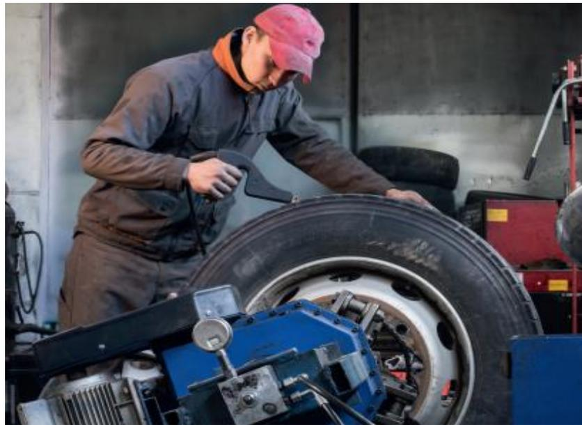
Figure 1. 2 : Pose d'une bande de roulement sur un pneu usagé [15].
