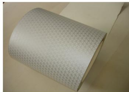
Figure 1.17 : Papier électromagnétiquement isolant composé de motifs périodiques [91].
