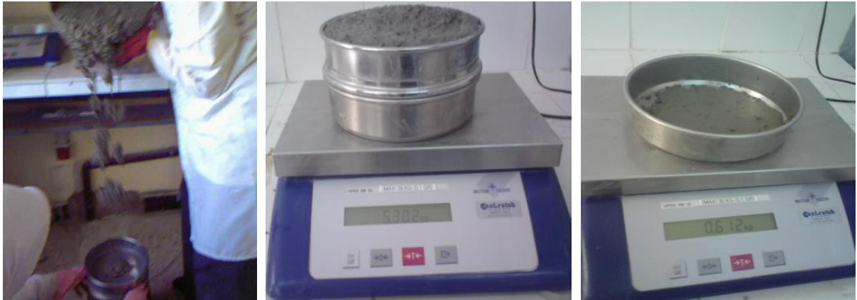
Figure 2.24 : Essai de stabilité dynamique au tamis.
