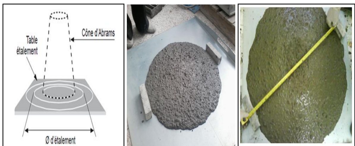
Figure 2.21 : Mesure du diamètre d'étalement.
