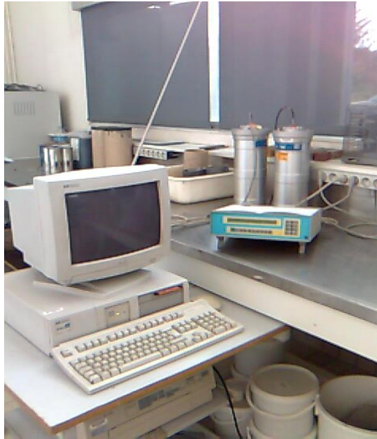
Figure 2.20 : Essai calorimétrique pour mesurer la chaleur d'hydratation.
