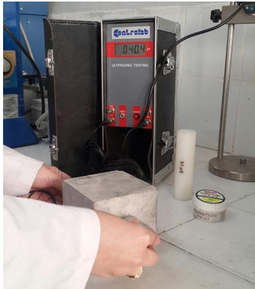
Figure 2.28 : Mesure de la vitesse ultrasonique.
