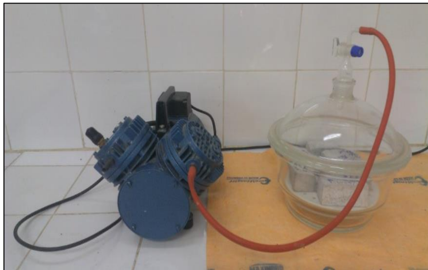
Figure 2.30 : Dessiccateur pour mettre les éprouvettes sous vide.
