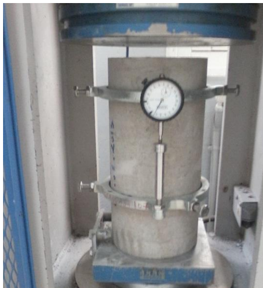
Figure 2.29 : Dispositif pour mesure du module d'élasticité sur béton.
