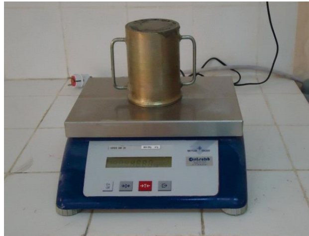
Figure 2.25 : Mesure de la masse volumique du béton frais.
