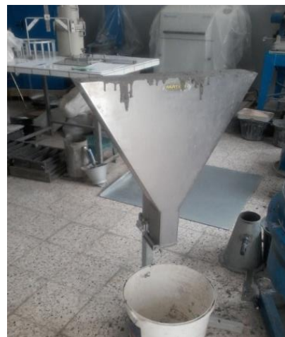
Figure 2.22 : Dispositif de l'essai d'entonnoir en V (V-Funnel).
