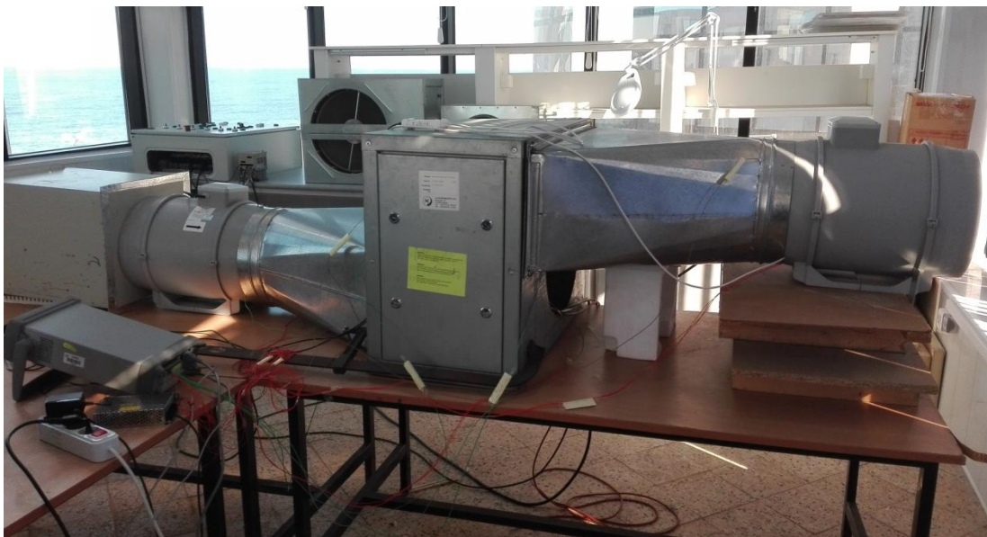
Figure 5.25 : Banc d'essai de caractérisation de la roue de dessiccation
