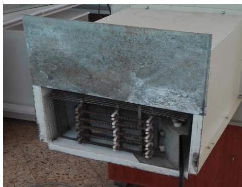
Figure 5.18 : Batterie électrique d'appoint
