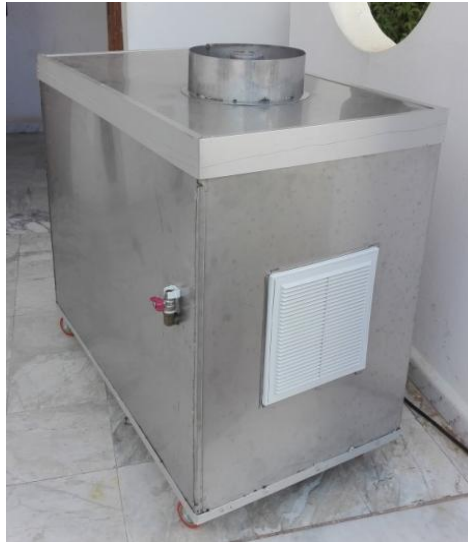
Figure 1.6 : Système de rafraîchissement par évaporation de l'équipe froid thermique - UDES
