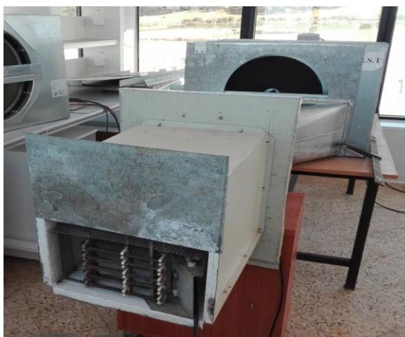
Figure 5.26 : Batterie de chauffe électrique reliée au banc d'essai
