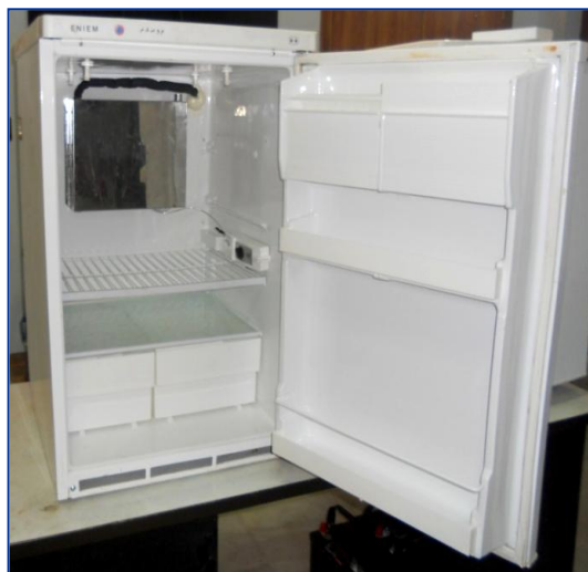
Figure 1.7 : Système de Réfrigération Solaire Photovoltaïque DC/AC de l'équipe Froid photovoltaïque - UDES
