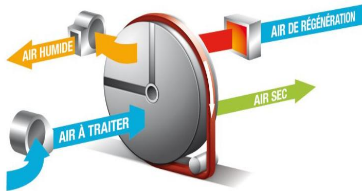
Figure 1.21 : La roue de dessiccation [31].
