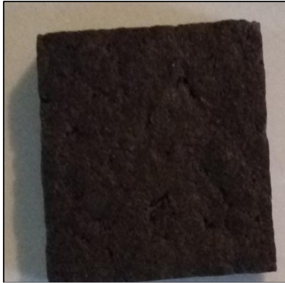
Figure 2. 9 Image d'un échantillon de composite-Vaseline élaboré
