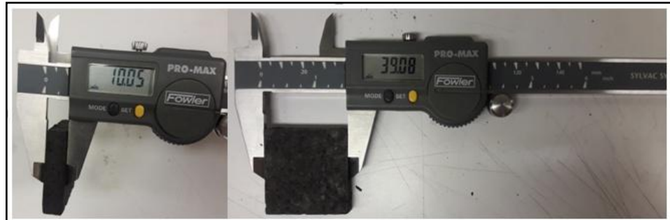
Figure 2. 28 Dimensionnement au pied à coulisse numérique des échantillons composites-MCP élaborés
