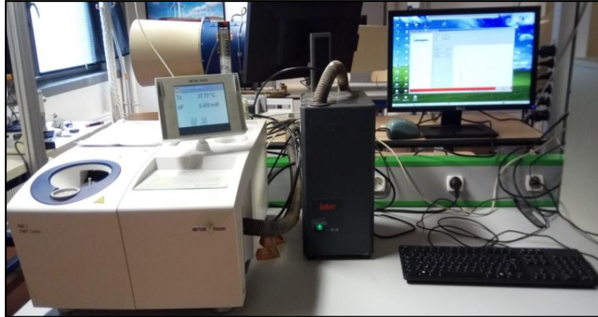
Figure 3. 1 Image du calorimètre DSC 1 STARe System de METTLER TOLEDO utilisé.
