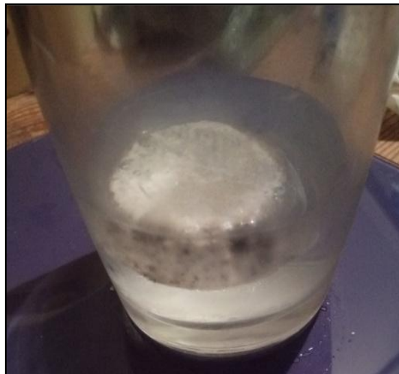
Figure 2. 27 Un exemple d'échantillon immergé dans l'eau pour tester sa perméabilité à l'eau
