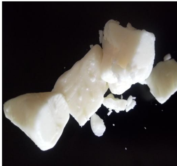
Figure 2. 12 Image d'un échantillon de la graisse végétale à 33 °C de point de fusion.
