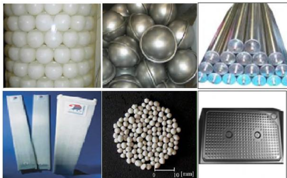
Figure1. 10 Quelques exemples d'MCP macro encapsulés dans différents types de capsules 125,126
