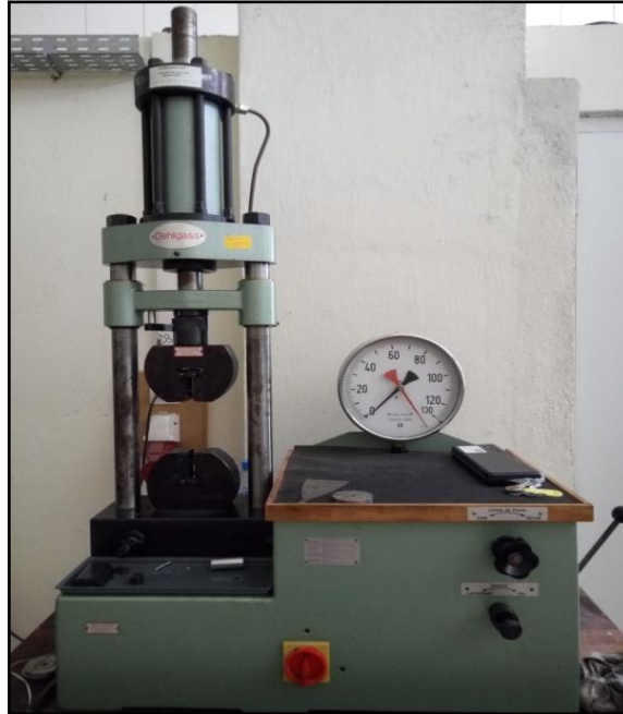
Figure 2. 21 Image de la presse hydraulique utilisée dans le processus de compression uniaxiale.
