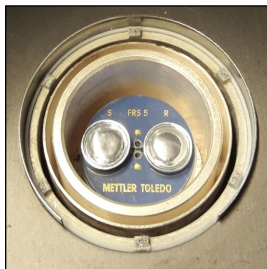
Figure 3. 2 Image des creusets "S" et "R" placés dans les fours DSC.
