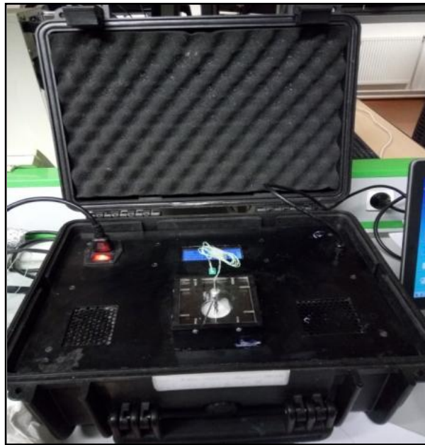
Figure 3. 7 Image du dispositif de vieillissement accéléré.
