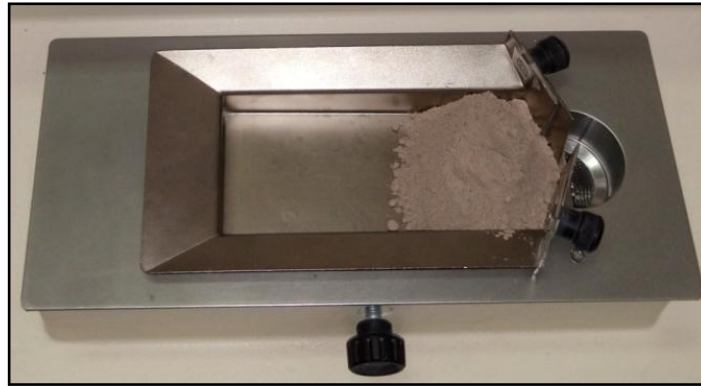
Figure 3. 16 Passeur d'échantillons de granulométrie laser
