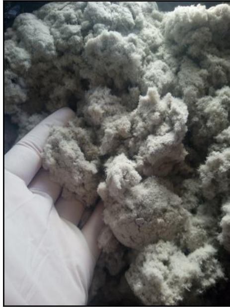
Figure 3. 27 Image des fibres de cellulose préparées au laboratoire.
