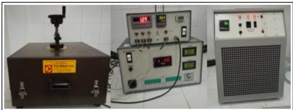
Figure 3. 3 Image du CT-mètre H112N pour la mesure de la conductivité thermique des matériaux de construction.
