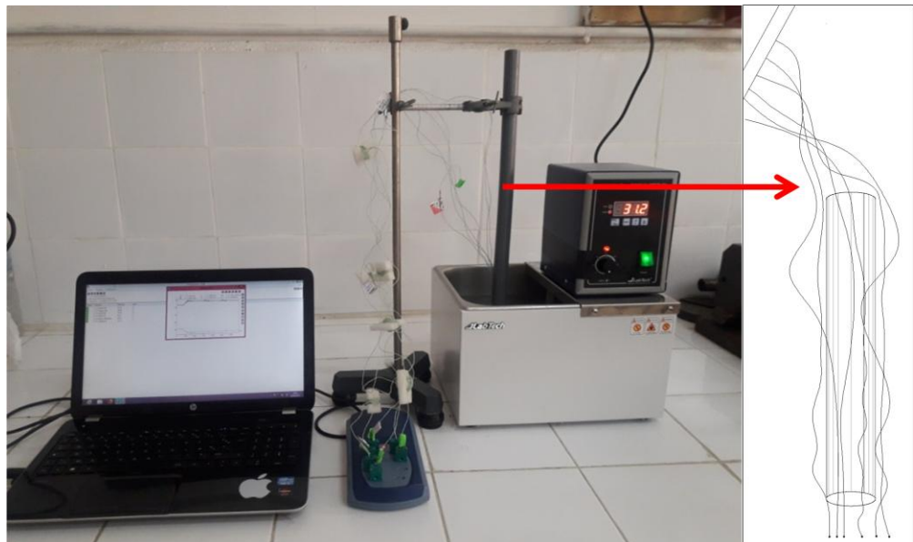
Figure 4. 12 Protocole expérimental d'étalonnage des thermocouples.
