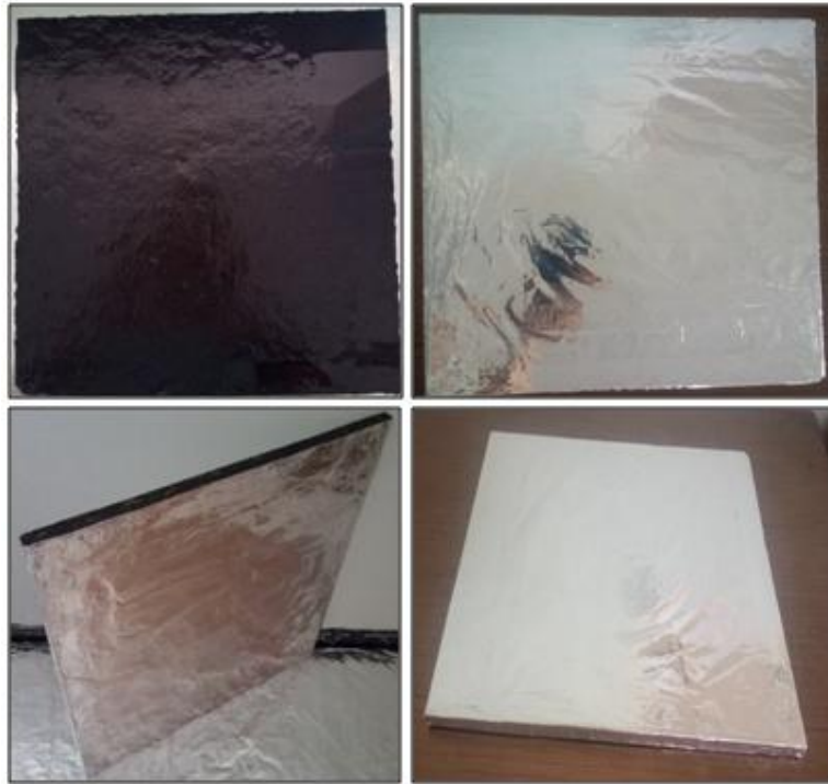
Figure 2. 31 Image des d'un exemple de panneau entièrement couvert par des feuilles d'aluminium.
