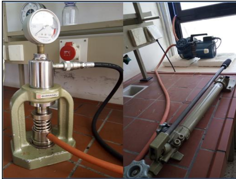
Figure 3. 12 Image du moule sous la presse à vide de SHIMADHU
