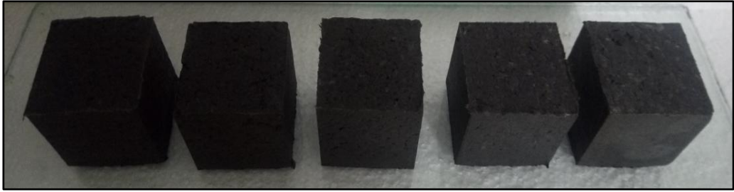
Figure 3. 17 Image des éprouvettes cubiques de caractérisation mécanique
