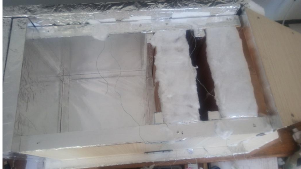
Figure 4. 5 : Image des parois intérieures du banc d'essais
