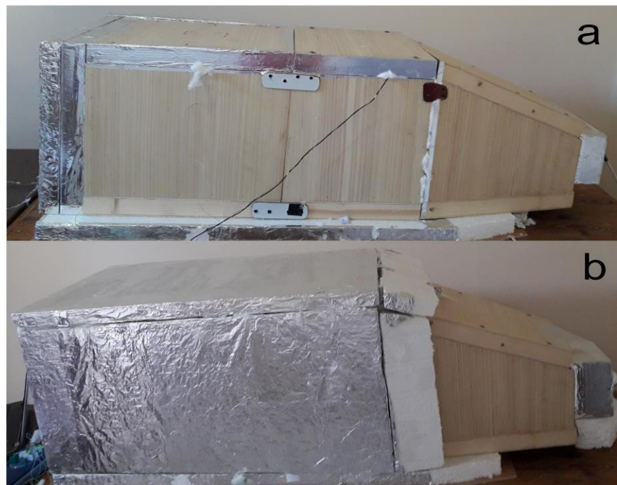
Figure 4. 4 : Image du banc d'essai monté : a) sans la double coque d'isolation, b) avec la double coque d'isolation.
