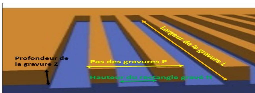
Figure 4.13 : Paramètres utilisées dans les gravures introduites dans le logiciel de FIB.
