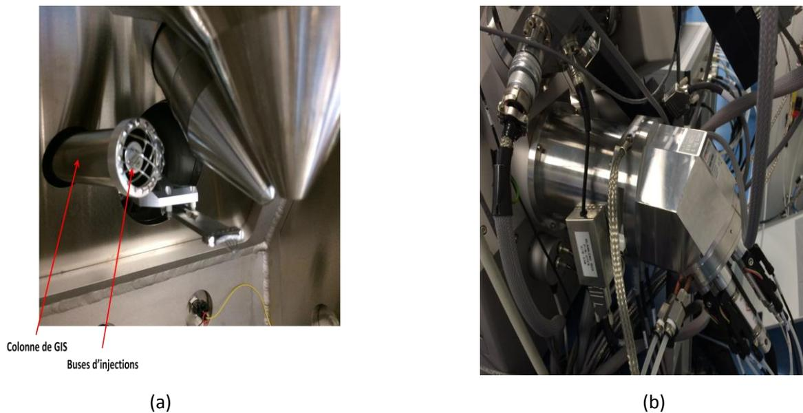
Figure 4.4 : Schéma d'injection de gaz GIS de l'équipe NSE de l'institut IM2NP. (a) colonne de GIS à l'intérieur de la chambre à vide de FIB ; (b) réservoir du GIS à l'extérieur de la chambre.
