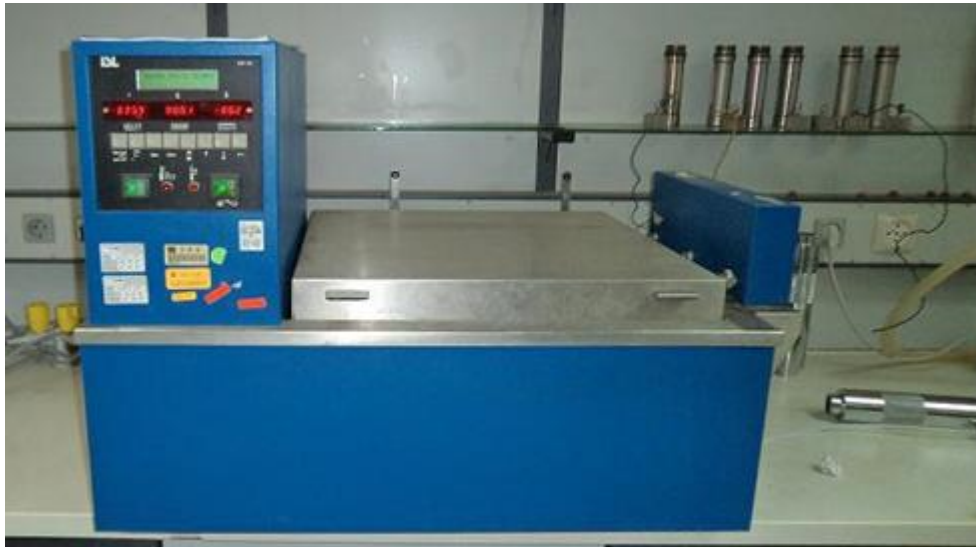
Figure 2.8 : Appareil de détermination de la TVR (ISL).
