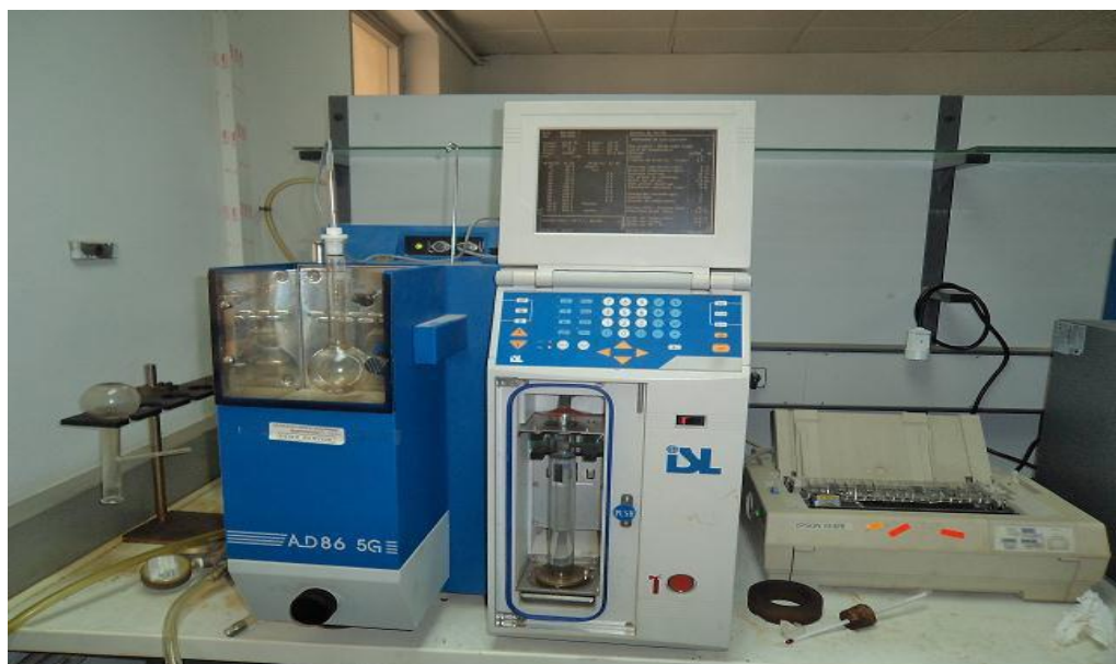
Figure B1 : Appareil de distillation ASTM D86 (ISL).
