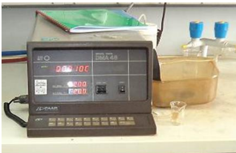
Figure 2.7 : Appareil de détermination de la densité (Densimètre électronique DMA 48 Anton PAAR)
