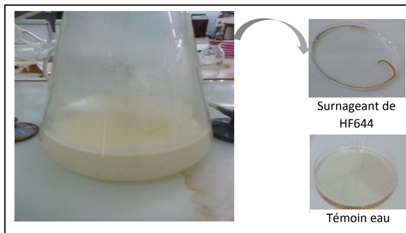
Figure 3.28 : Activité de surface maximale du biosurfactant HF644 produit par M. hydrocarbonoclasticus SdK644 à partir de l'huile de friture.
