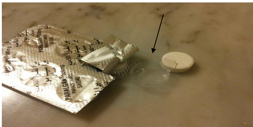
Figure 6.1 : Préparation des alvéoles pour analyse par FTIR
