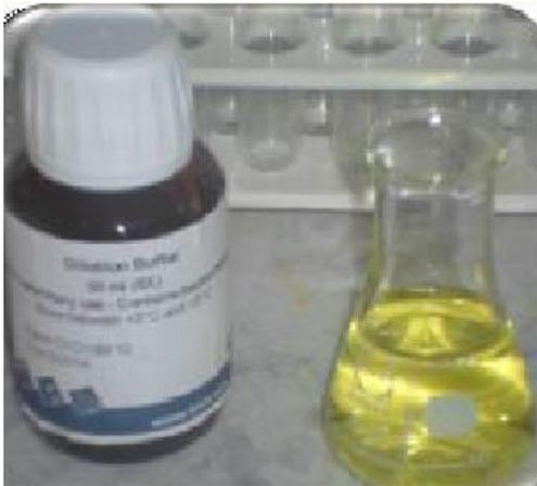
3-Dilution avec solution tampon (Buffer solution) 0,5 ml d'échantillon + 0,5 ml de diluent.
