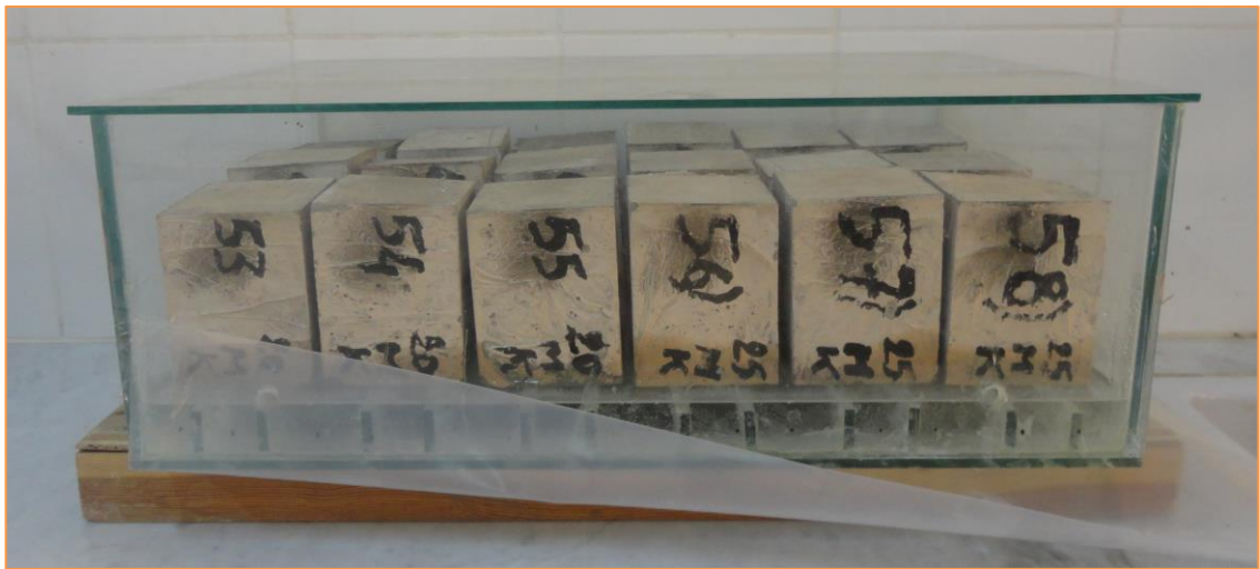
Figure 4.21 – Essai d'absorption capillaire.
