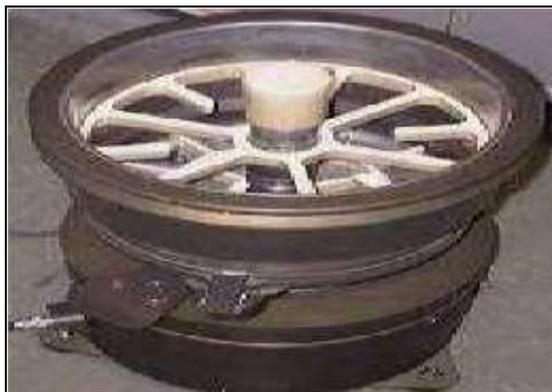
Figure .1.28 : Rhéomètre BTRHEOM [121].
