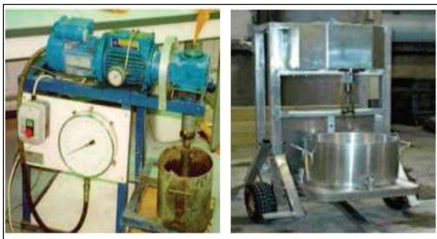
Figure .1.26: Rhéomètres « Two-point-test » et « IBB » de gauche à droite [119].
