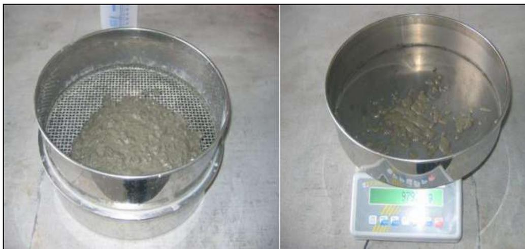
Figure 1.22: Essai de stabilité au tamis [99].
