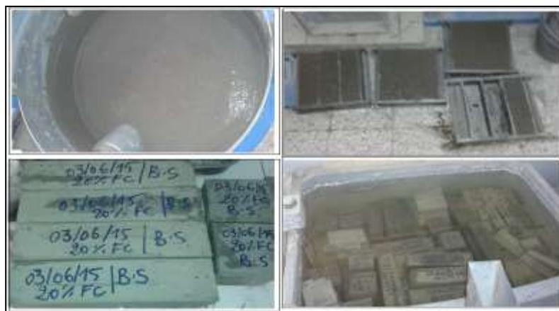
Figure 3.17 : Conservation des éprouvettes.
