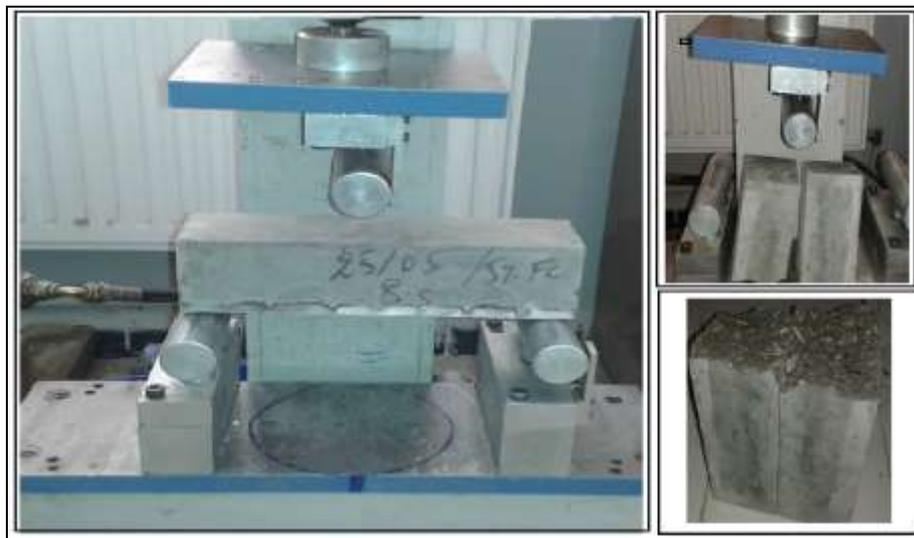
Figure 3.19: Essai de traction par flexion.
