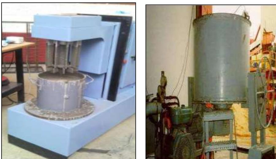
Figure .1.27: Rhéomètres « BML» et « Cemagref » de gauche à droite [123].
