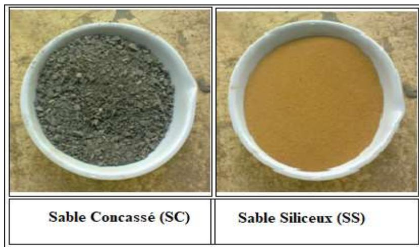
Figure 3.1: Texture et forme des particules des deux sables.
