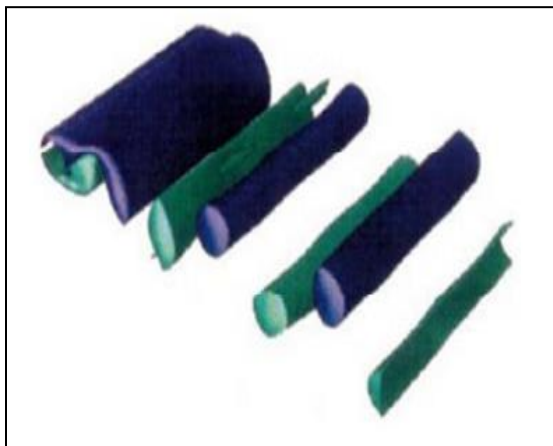
(a) Ondulation des tourbillons de Von Karman pour le mode A, Re = 220 , Braza et al. [14].
