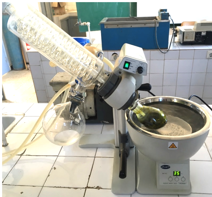
Figure.4. Évaporation du solvant dans l'évaporateur rotatif (Originale, 2015).
