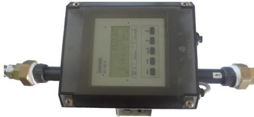
Figure 5.6. Débitmètre à électromagnétique
