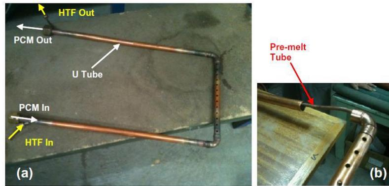
Figure 2.10. Échangeur avec recirculation du MCP imaginé par N.H.S. Tay et al. [54]
