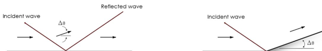
Figure 2.5 : Principe de conception d'une paroi bidimensionnelle
