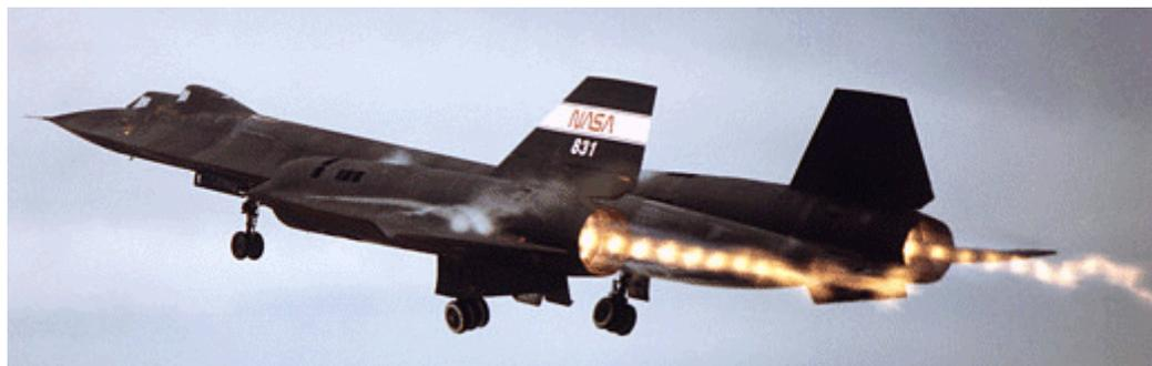
Figure 1.5 : Description du flux en sur-détente
