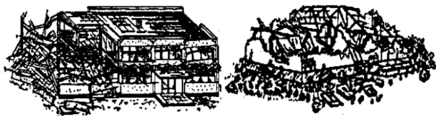
Figure 2.10 : Niveau de dommage « D5 » [9]
