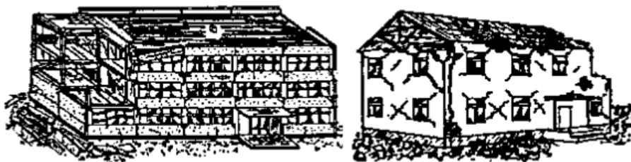
Figure 2.9 : Niveau de dommage « D4 » [9]
