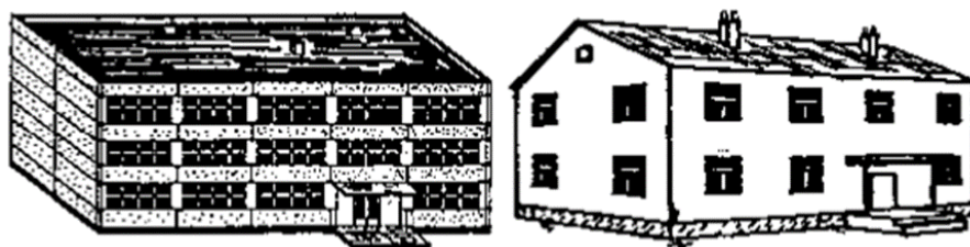
Figure 2.6 : Niveau de dommage « D1 » [9]
