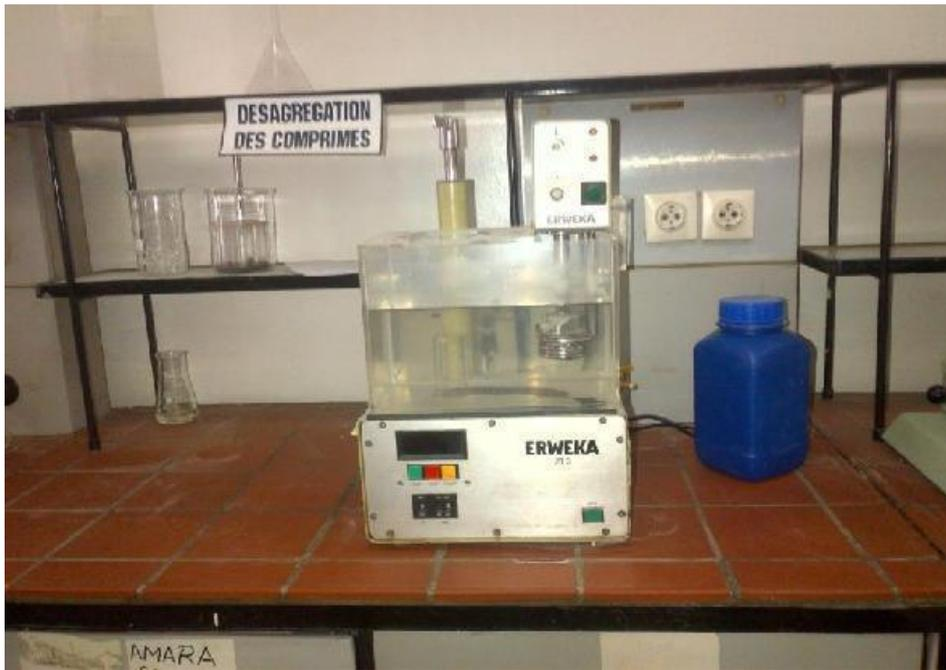
**Figure 39 :** Appareil de désagrégation ERWEKA (Allemagne)
