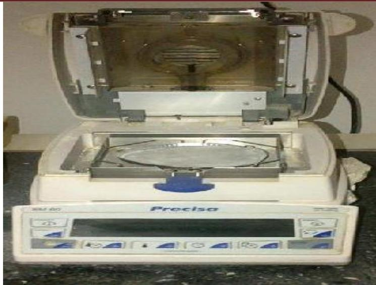
**Figure 37** : Dessiccateur thermobalance PRECISA Modèle XM60 (France)
