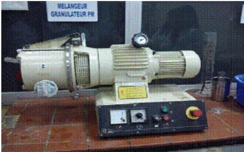
**Figure 32 :** Mélangeur granulateur petit modèle LÖDIGE (Allemagne)
