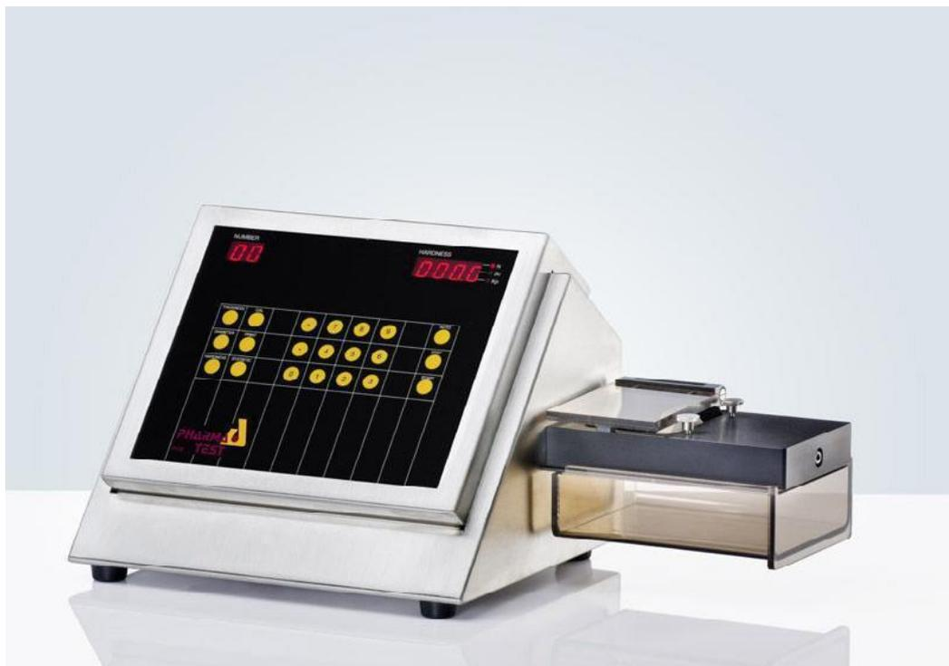
**Figure 38** : Duromètre Type PHARMATEST (Allemagne)
