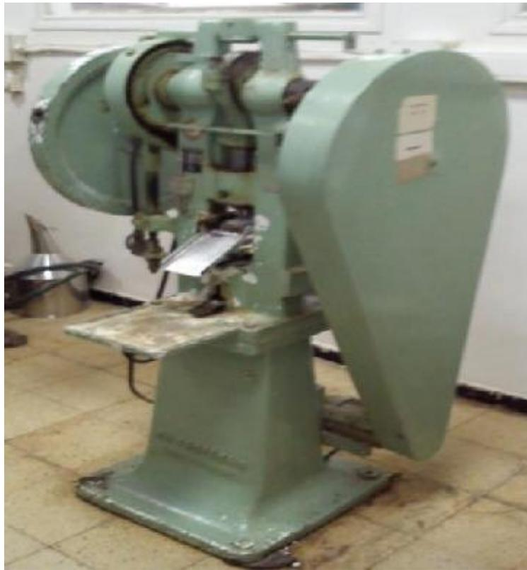
**Figure 36** : Comprimeuse alternative Type FROGERAIS (France)
