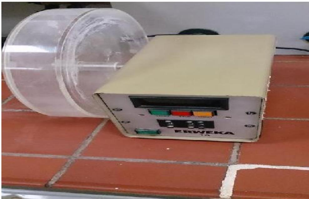
**Figure 40:** Friabilimètre ERWEKA (Allemagne)
