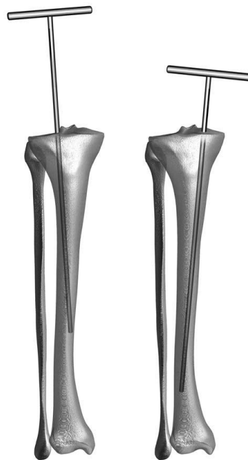
Figure 96. Axes érronés et mauvaises coupes par mauvais choix du point d'entrée de la tige. G.Gagon [16]
