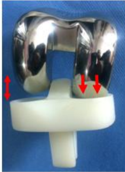
Figure 36. Décoaptation avec soulèvement de l'implant fémoral en flexion (lift-off).
